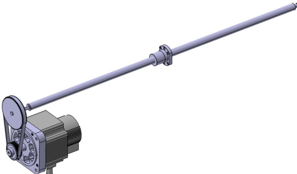
Slika 11. Model posmičnog prigona za pravocrtno gibanje
