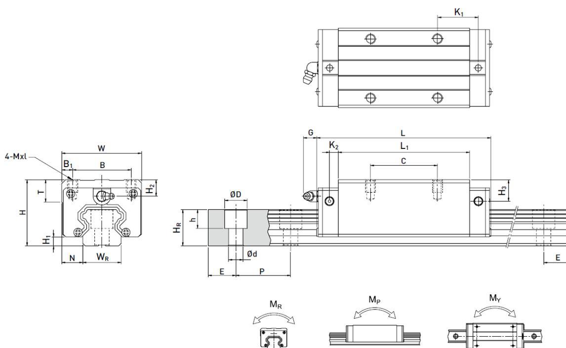
Slika 28. Dimenzijske karakteristike odabrane kuglične linearne vodilice [11]
