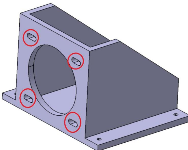
Slika 22. Nosač servo motora
