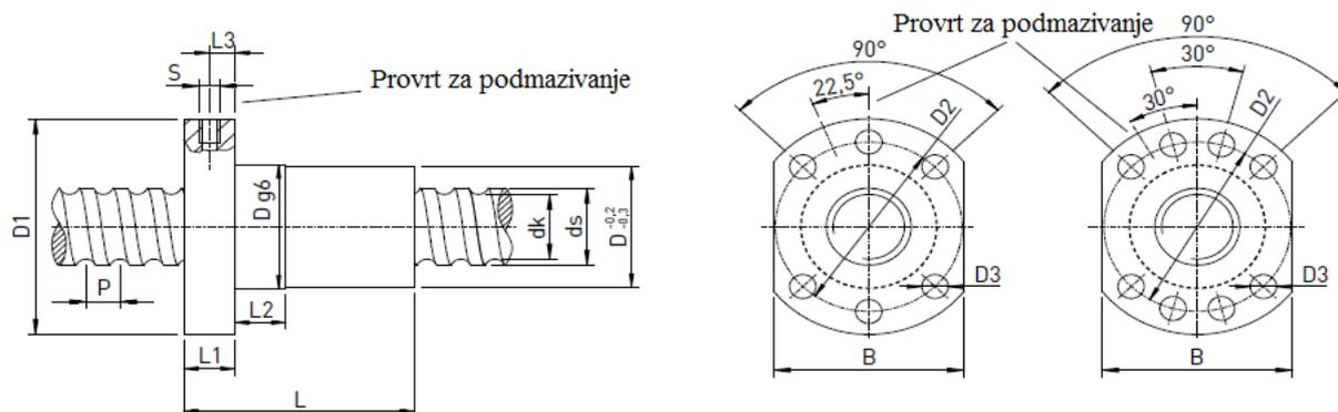
Slika 13. Dimenzijske karakteristike kugličnog navojnog vretena i matice [11]
