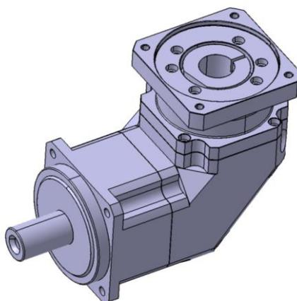
Slika 30. Planetarni reduktor
