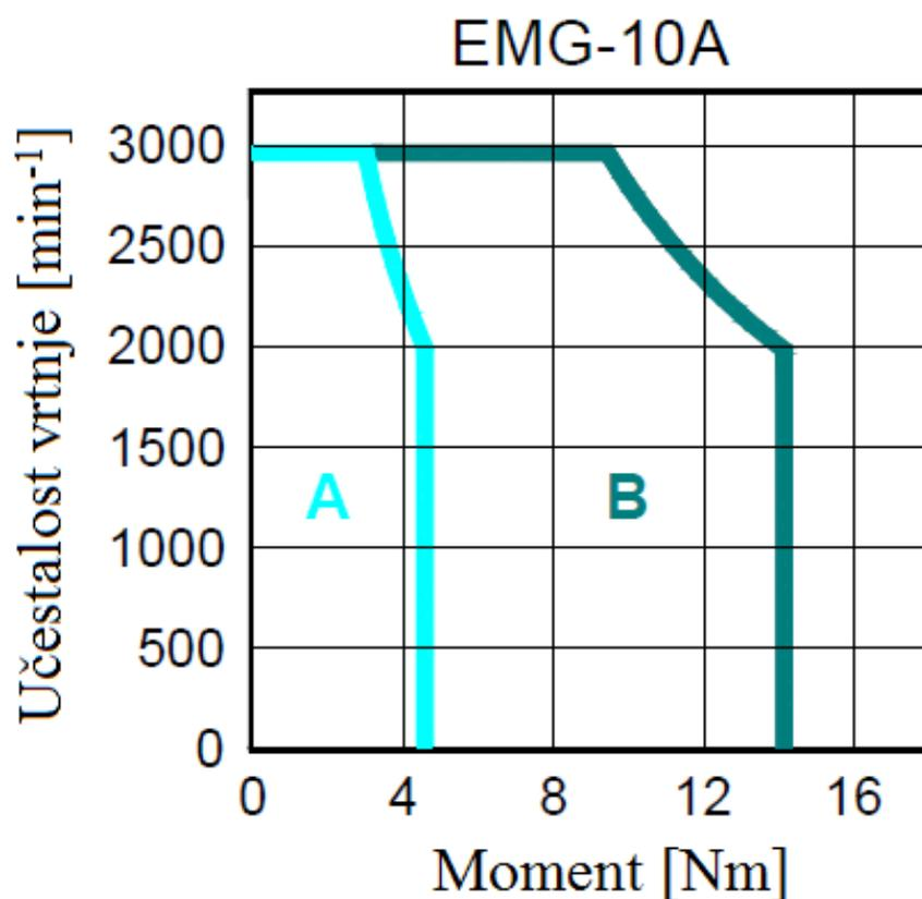
Slika 19. Momentna karakteristika servo motora ESTUN EMG-10A [13]
