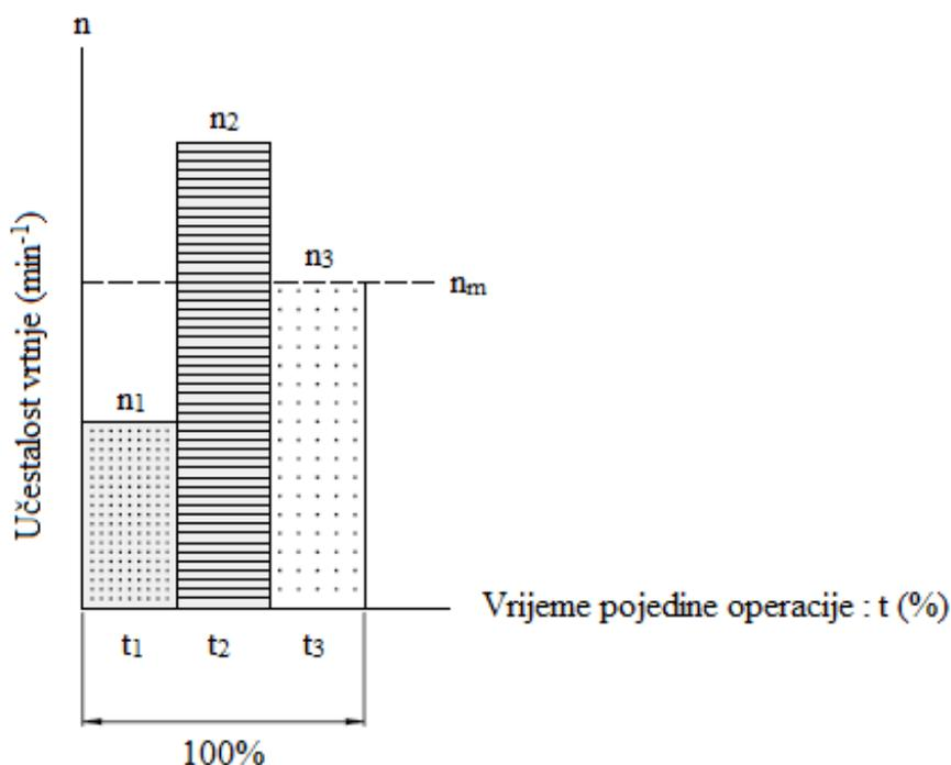
Slika 12. Prosječna učestalost vrtnje kugličnog navojnog vretena [11]
