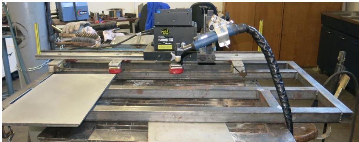
Slika 34. Oprema za automatizirano plazma zavarivanje
