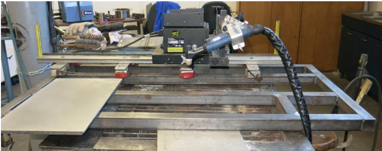
Slika 34. Oprema za automatizirano plazma zavarivanje
