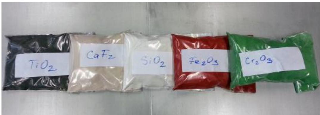
Slika 31. Aktivacijske komponente premaza [31]
