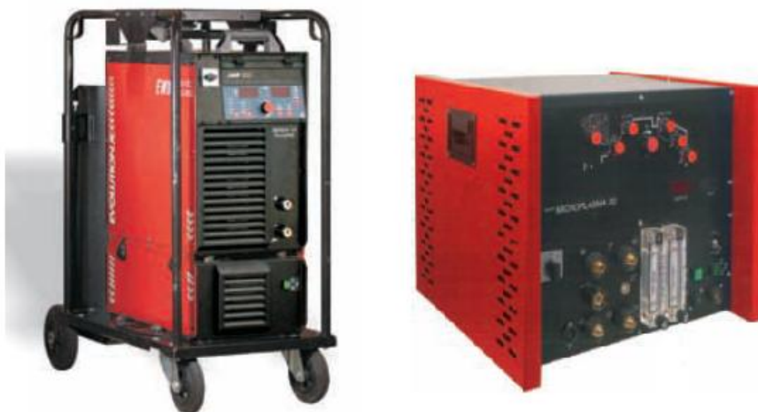
Slika 14. Inverterski uređaji za plazma zavarivanje [17]
