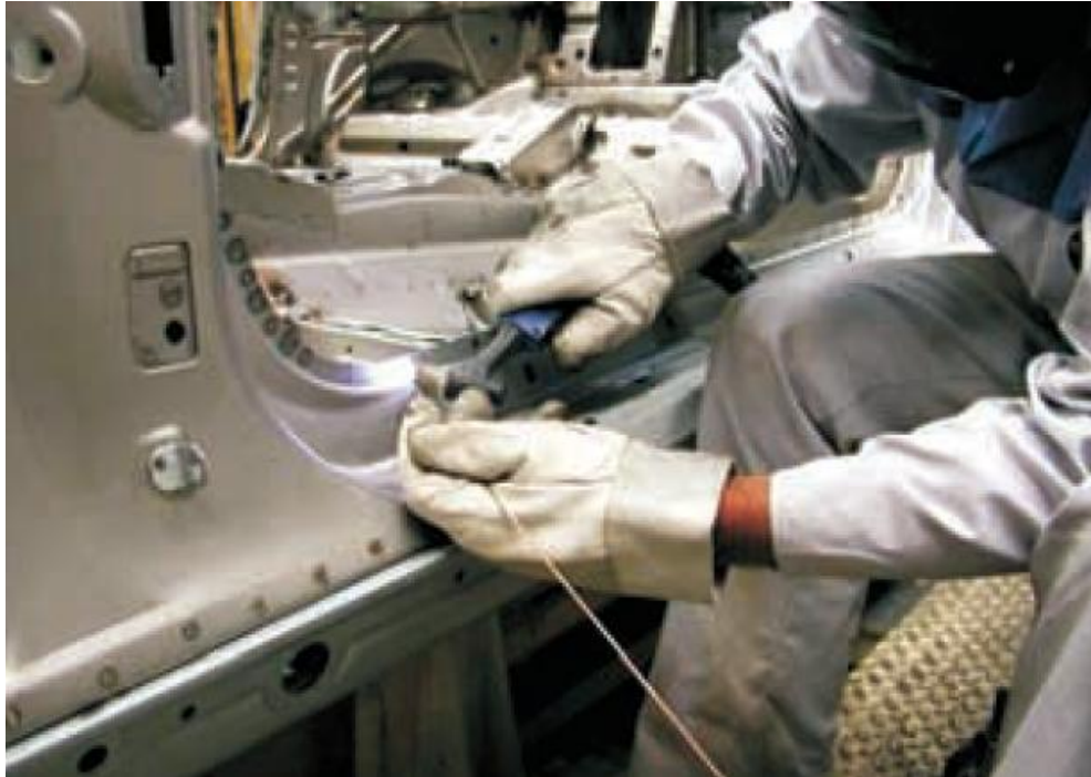
Slika 25. Ručno plazma zavarivanje u BMW-oj tvornici [17]
