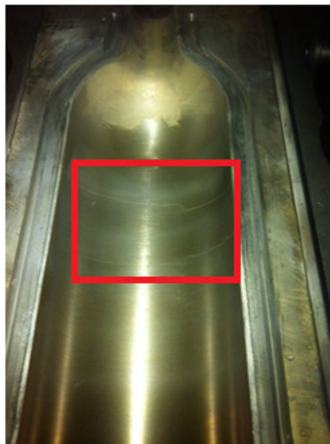
Slika 96. Istrošenost brončanog kalupa- primjer 1
