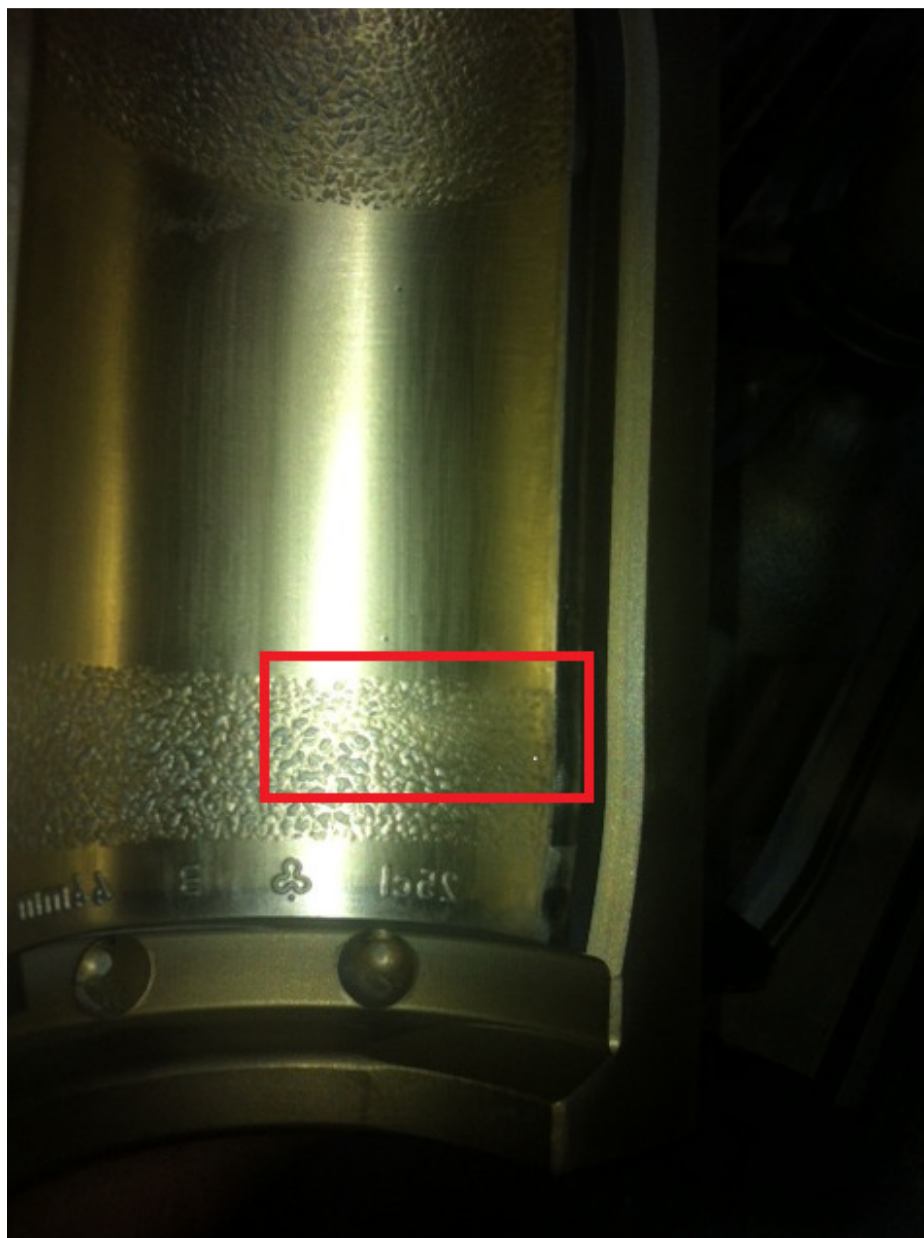
Slika 101. Istrošenost brončanog kalupa za Coctu- primjer 2
