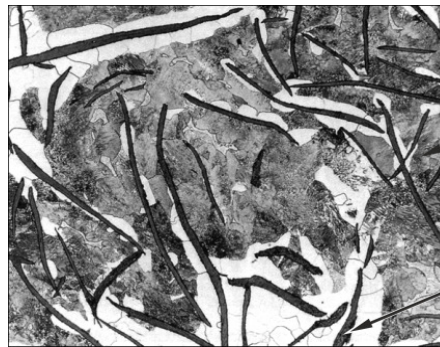
Slika 68. Mikrostruktura perlitno-feritnog sivog lijeva, povećanje 250:1[18]
