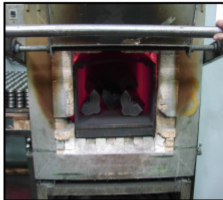
Slika 11. Zagrijavanje polovica kalupa u specijalnoj peći[2]
