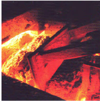
Slika 42. Taljenje staklene smjese[10]
