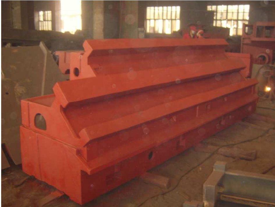
Slika 73. Postolje tokarskog stroja[17]
