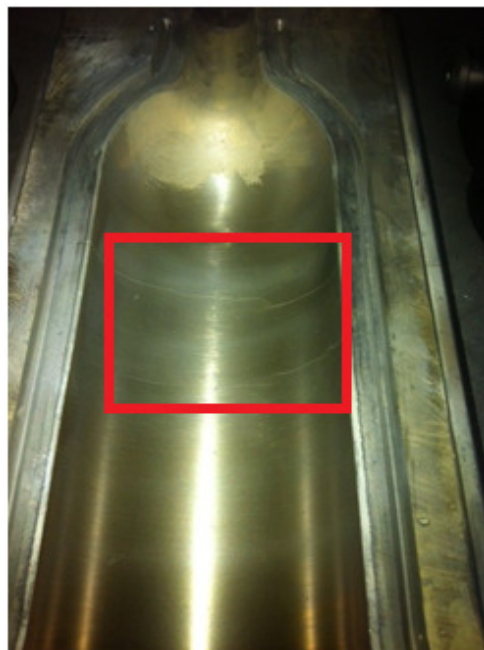
Slika 96. Istrošenost brončanog kalupa- primjer 1
