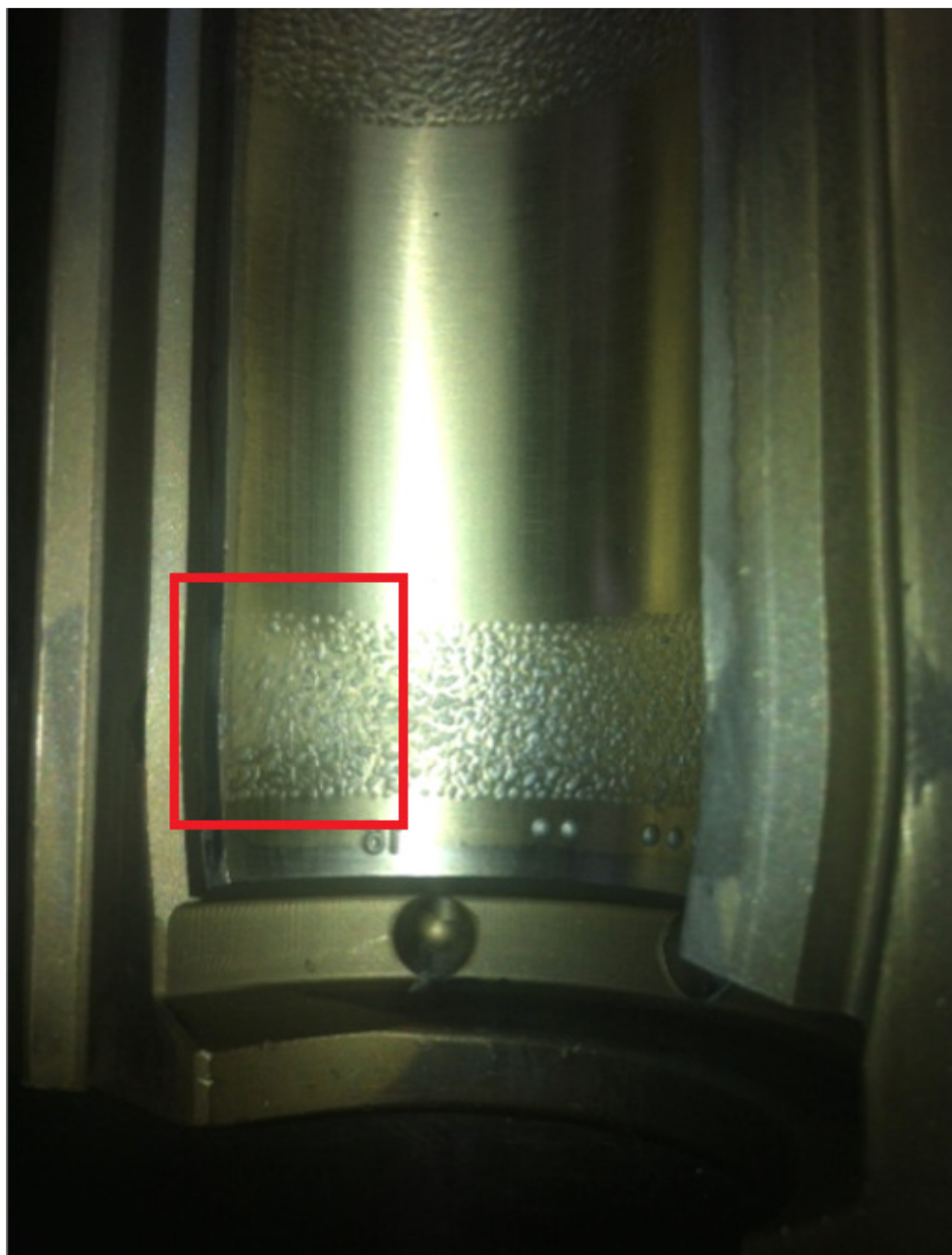
Slika 100. Istrošenost brončanog kalupa za Coctu- primjer 1
