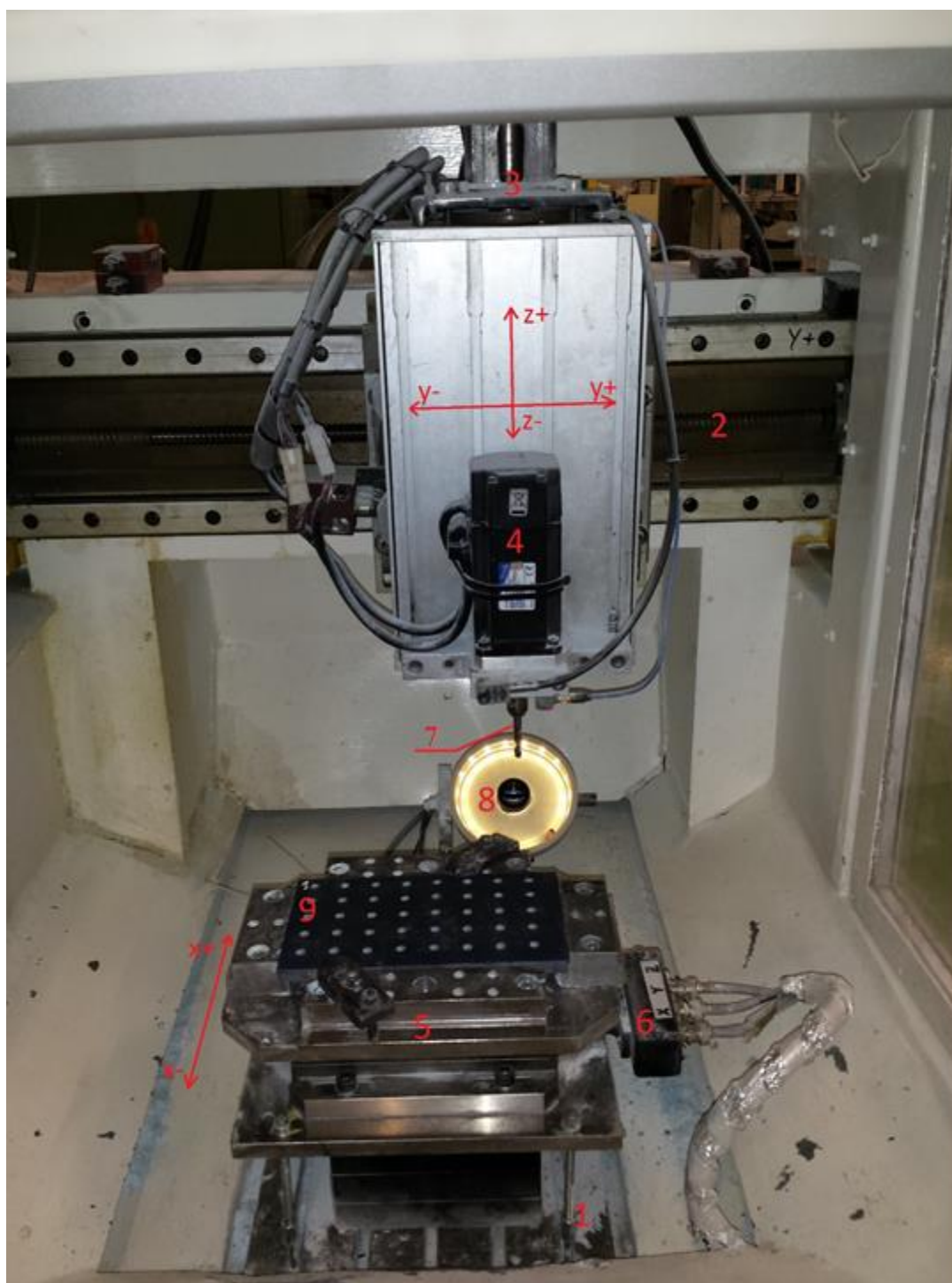
Slika 37 Radni prostor stroja; 1. Posmični prigon X osi, 2. Posmični prigon Y osi, 3. Posmični prigon Z osi, 4. Glavno vreteno, 5. Stezna naprava, 6. Senzor sile, 7. Ispitno svrdlo, 8. Industrijska kamera s rasvjetom, 9. Ispitni uzorak.
