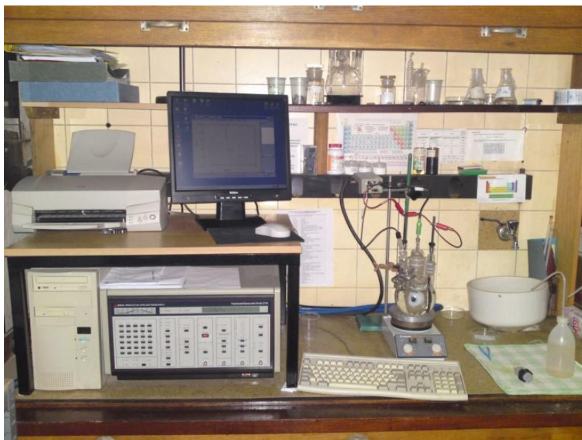
Slika 26. Oprema za DC ispitivanja [22]
