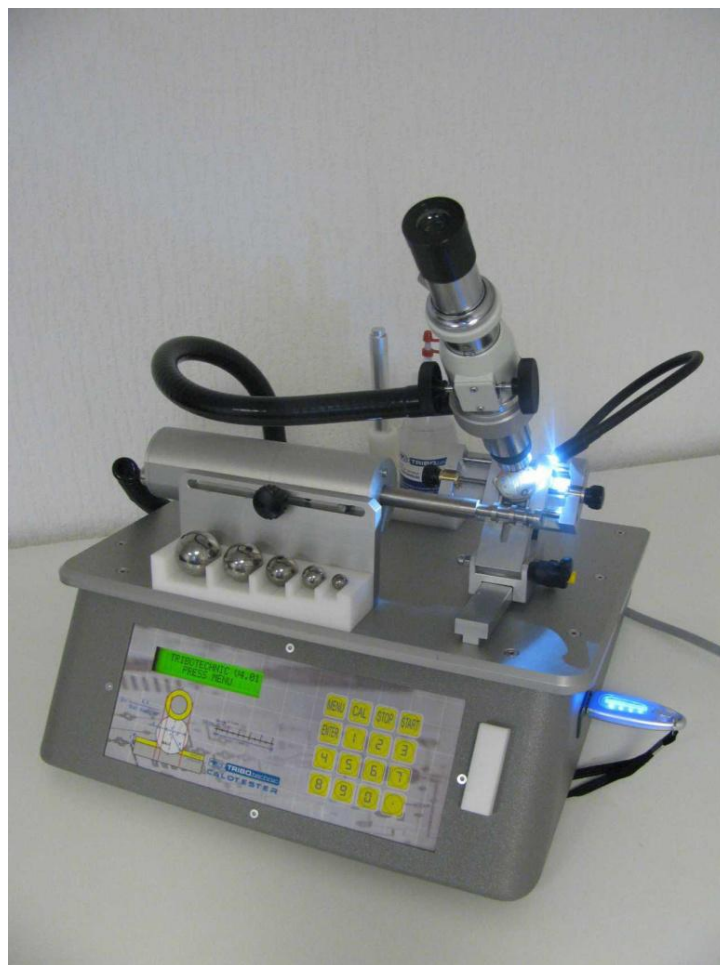
Slika 22. Kalotester za mjerenje debljine sloja [21]
