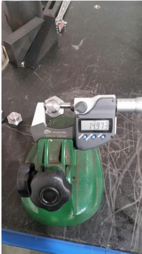
Slika 38. Mjerni instrument digitalni mikrometar
