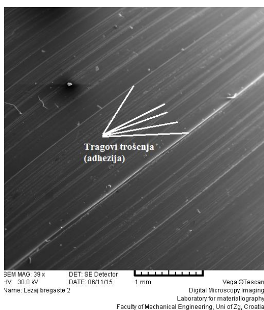
Slika 64. SEM analiza – osovina (rukavci ležajeva)
