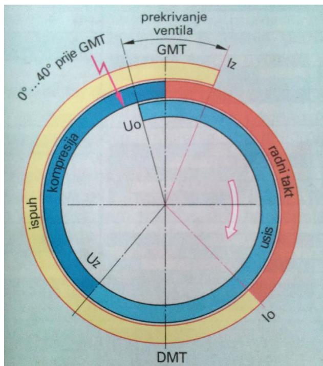
Slika 19. Razvodni dijagram četverotaktnog Otto motora [1]
