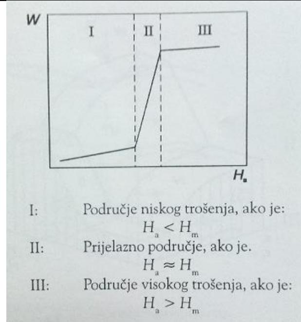
**Slika 40. Ovisnost abrazijskog trošenja o tvrdoćama abraziva i materijala [20]**
