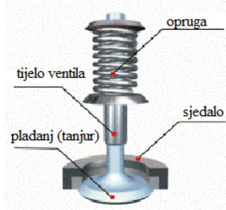
**Slika 10. Konstrukcija ventila [11]**
