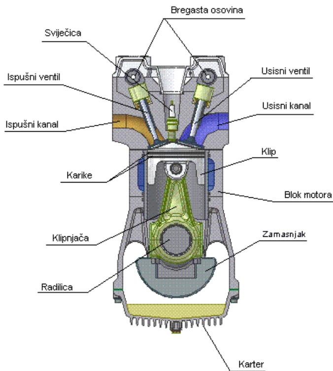
**Slika 1. Konstrukcija Ottova motora [ 2]**
