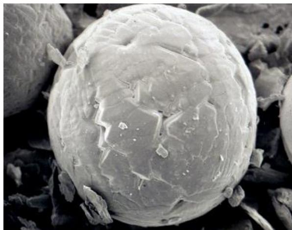
Slika 47. Kuglasta čestica trošenja nastala umorom površine [27]
