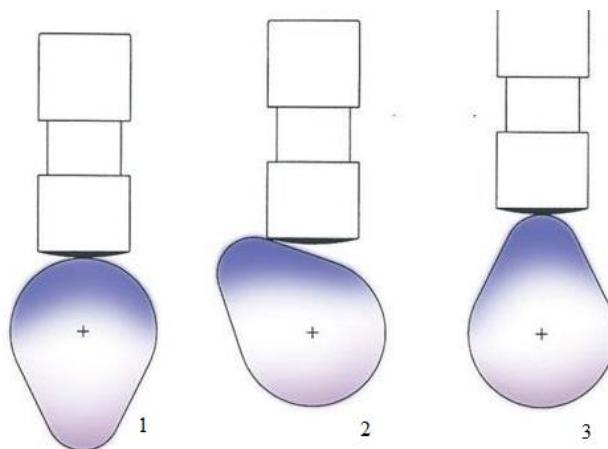
Slika 7. Princip otvaranja i zatvaranja ventila [8]
