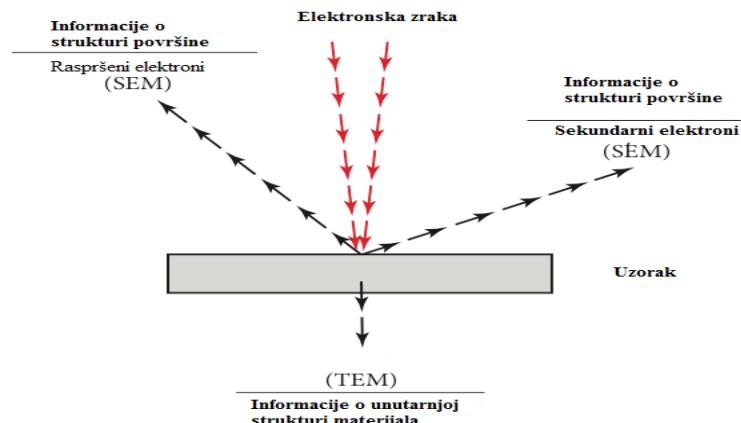
**Slika 56. Princip rada SEM [31]**
