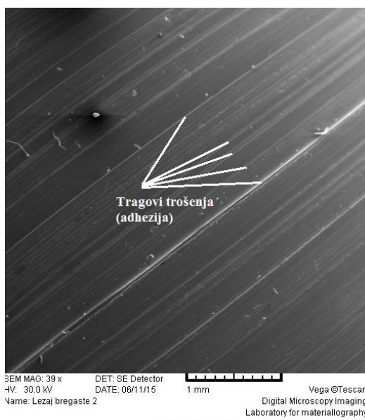
**Slika 64. SEM analiza – osovina (rukavci ležajeva)**
