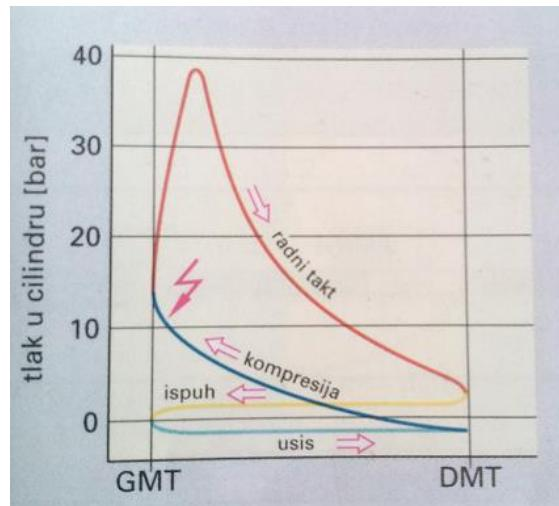
Slika 18. Stvarni dijagram četverotaktnog Otto motora [1]
