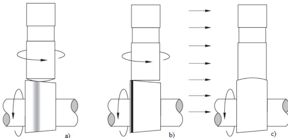
Slika 8. Proces trošenja brijega i podizača [9]
