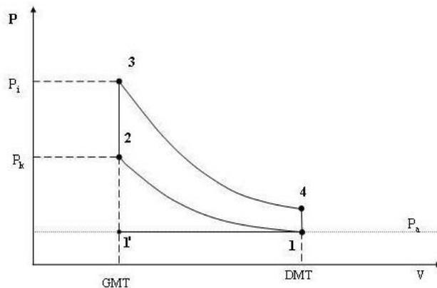
Slika 17. Teoretski dijagram četverotaktnog Otto motora [13]
