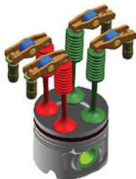
Slika 9. Viševentilska tehnika (4 ventila) [10]
