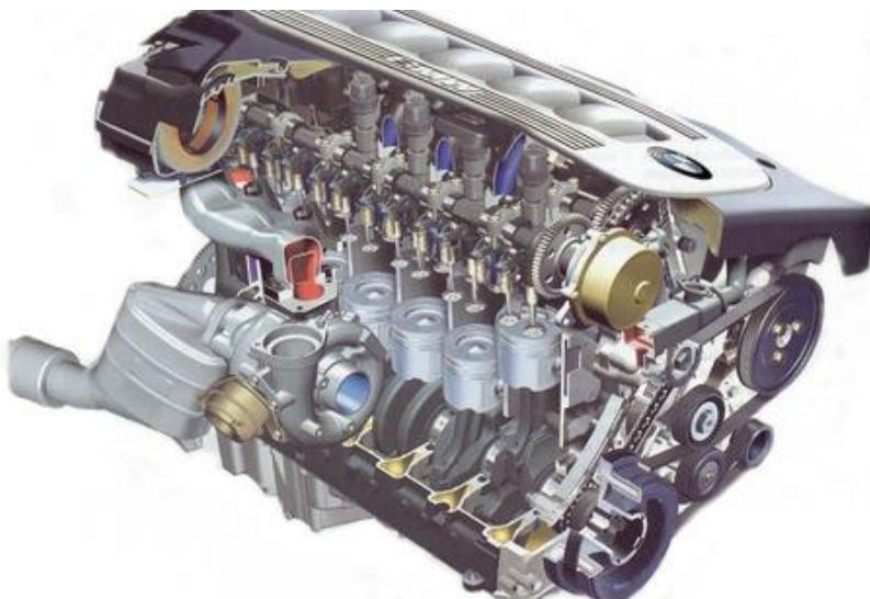
Slika 20. Četverotaktni Otto motor –BMW [19]
