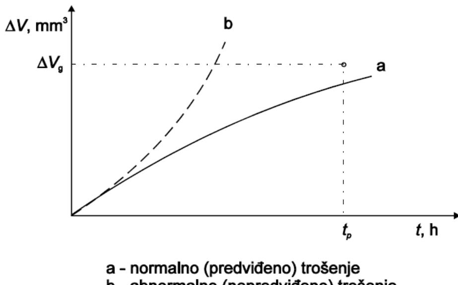
Slika 49. Opći oblik procesa trošenja [22]
