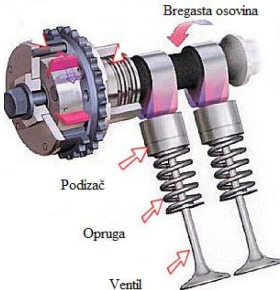
**Slika 2. Razvodni mehanizam bregasta osovina – ventili [3]**
