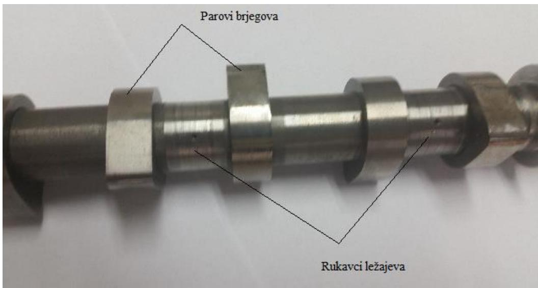
**Slika 50. Ispitivana bregasta osovina s tragovima povećanog trošenja**
