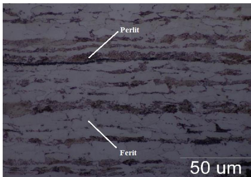
**Slika 54. Mikrostruktura materijala osovine (povećanje 1000 puta)**
