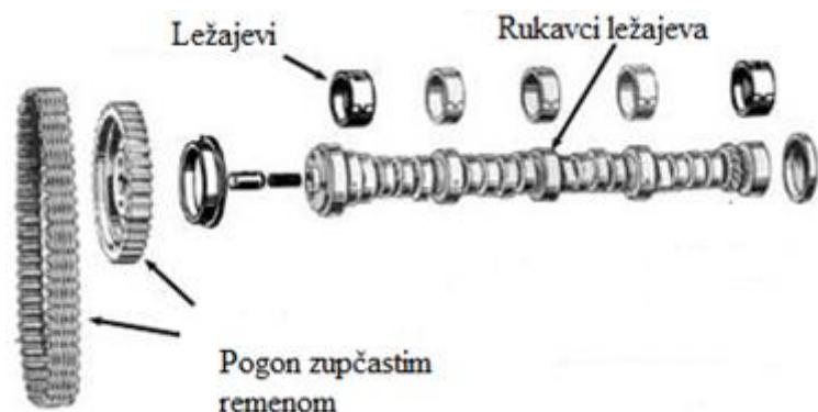
Slika 4. Sklop bregaste osovine i ležajeva [5]
