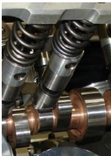
Slika 52. Kontakt brijeg – podizač ventila [28]
