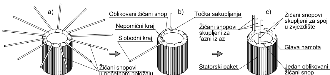
Slika 2. Proces oblikovanja žičanih snopova
