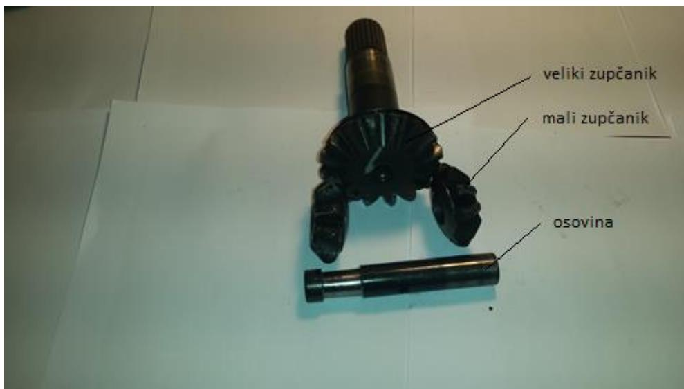
Slika 28. Zupčanici diferencijalnog prijenosa
