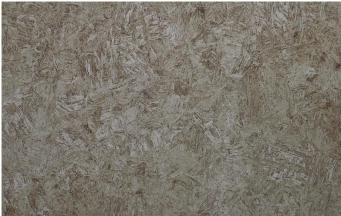
Slika 39b. Mikrostruktura malog zupčanika- sredina, povećanje 500x
