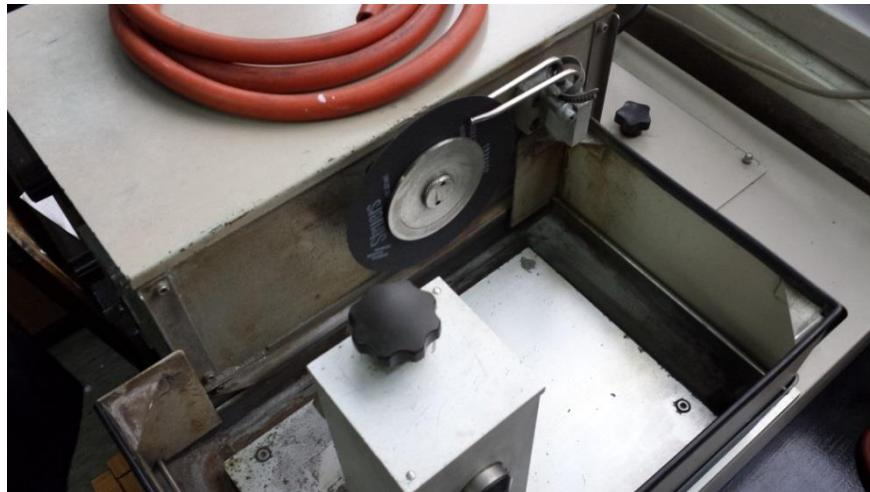
Slika 36. Stroj za rezanje uzorka za analizu.
