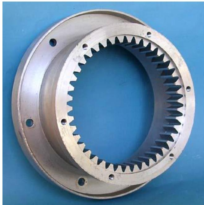
Slika 10. Unutarnji zubi zupčanika dobiveni iglom za provlačenje [4]
