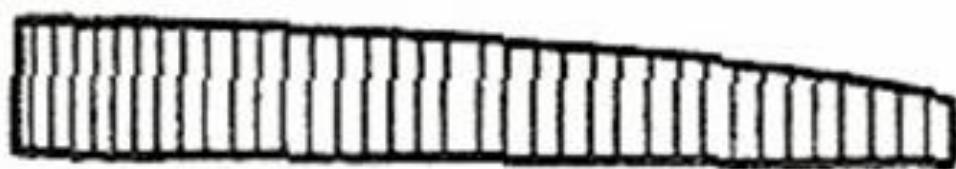
Slika 14a. Neparalelnost površine [7]
