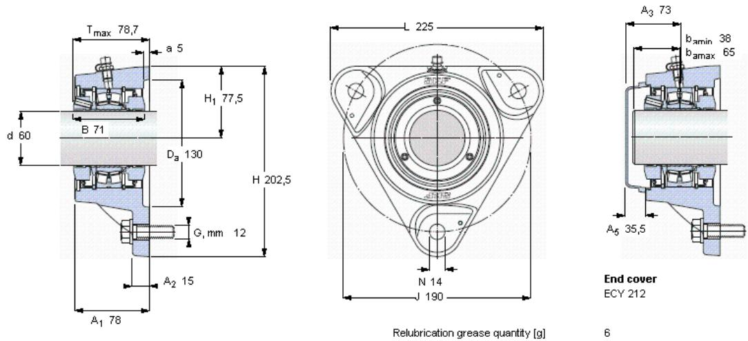
Slika 36 Dvostruki valjkasti ležaj sa prirubnicom FYNT 60
