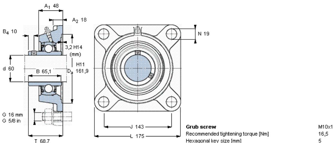
Slika 37 Kuglični ležaj sa prirubnicom FYJ 60
