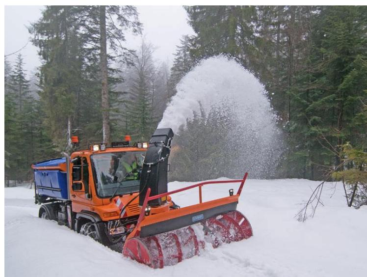
Slika 10. Puhalica pričvršćena za vozilo od kojeg dobiva i moment
