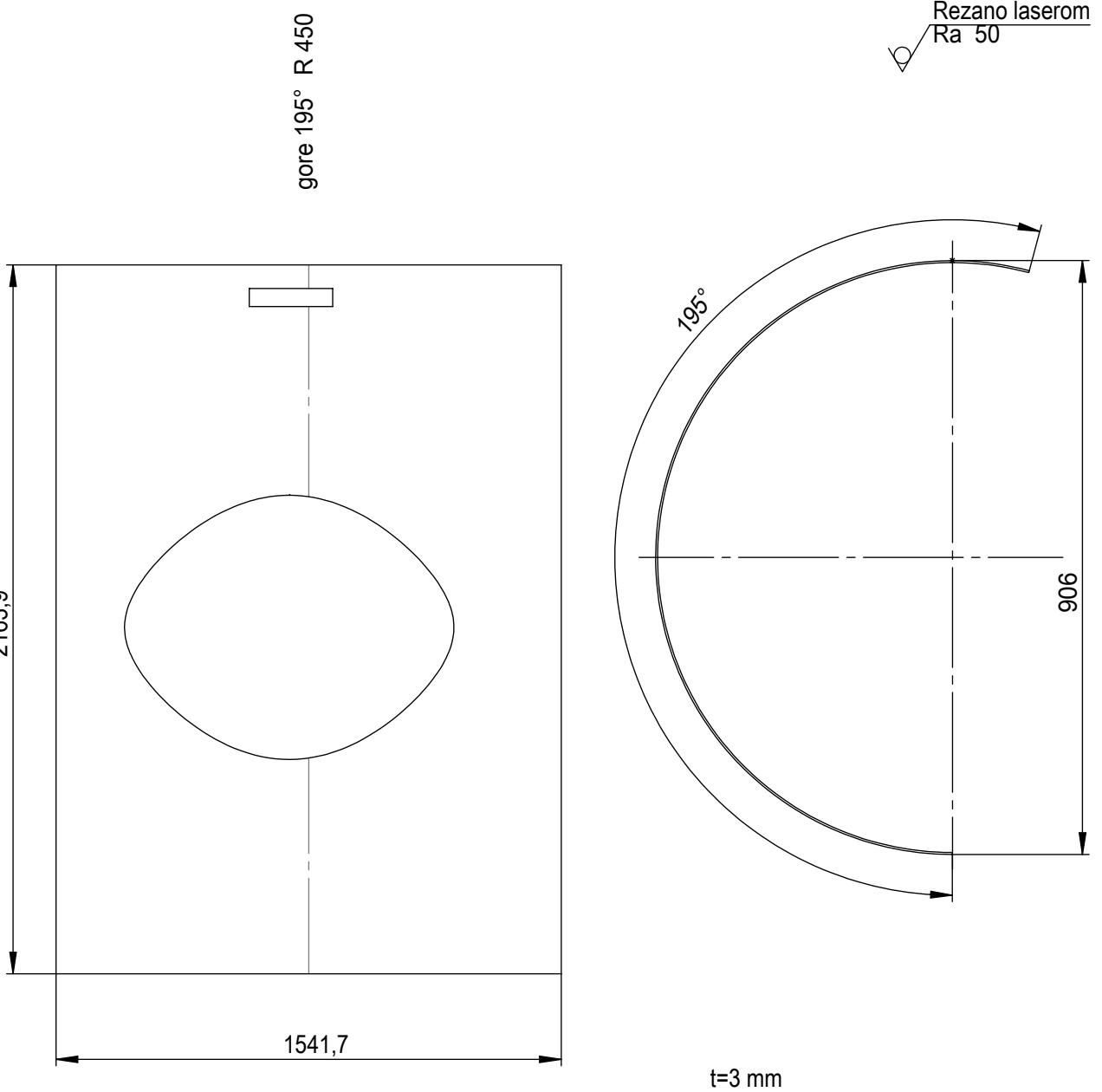
Napomena: Lijevi prikaz je nacrt lima prije savijanja a desno od njega je prikaz u savijenom obliku. Zbog kompleksnosti oblika rezati na CNC stroju.
