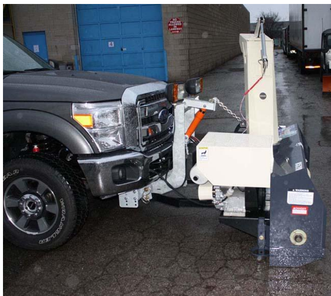
Slika 9. Puhalica sa vlastitim pogonom samo pričvršćena za vozilo
