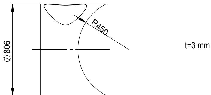
Napomena: Gornji prikaz je nacrt lima prije savijanja a ispod njega je prikaz u savijenom obliku. Zbog kompleksnosti oblika rezati na CNC stroju.
