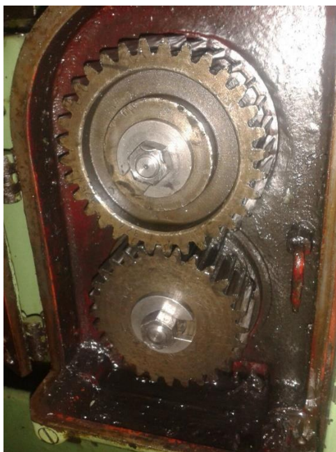
Slika 3.3 Zupčanički prijenosnici za namještanje brzine rezanja
