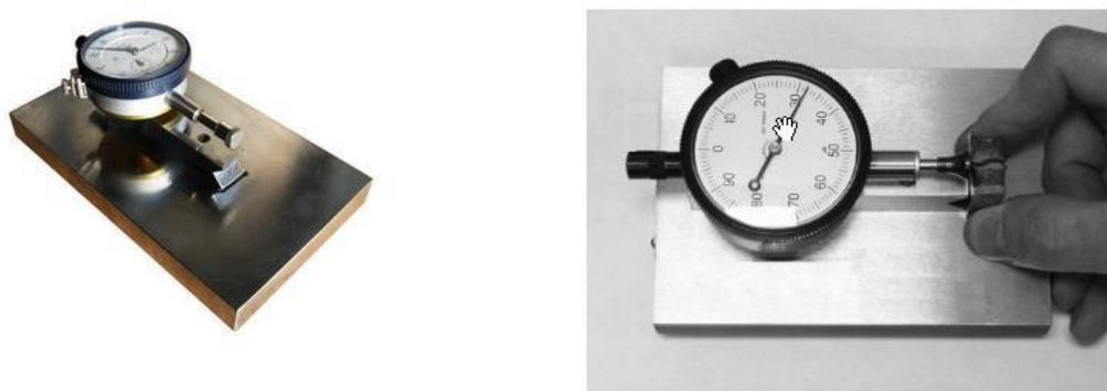
Slika 15. Mjerni sat za mjerjenje bočnog širenja [9]
