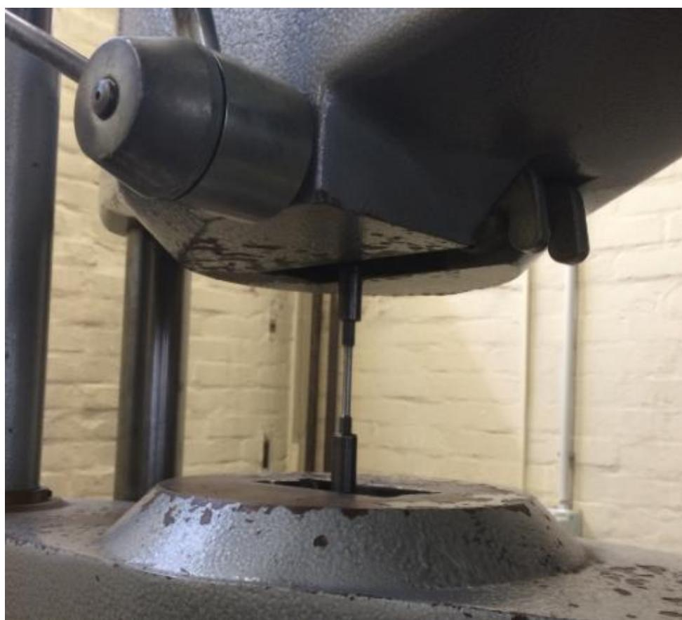
**Slika 51. Učvršćivanje epruvete**
