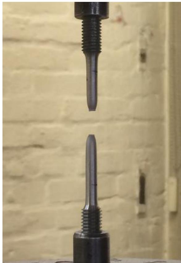
**Slika 54. Lom epruvete**
