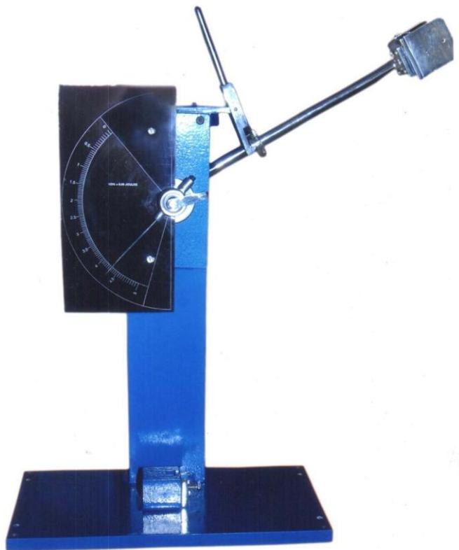
Slika 22. Uredaj za ispitivanje Izod metodom [9]
