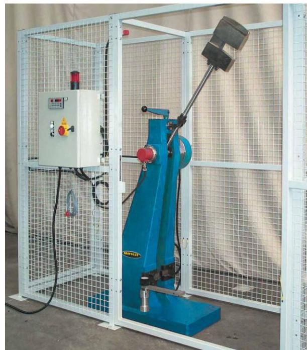
Slika 10. Uredaj za ispitivanje Charpy metodom, Atico
