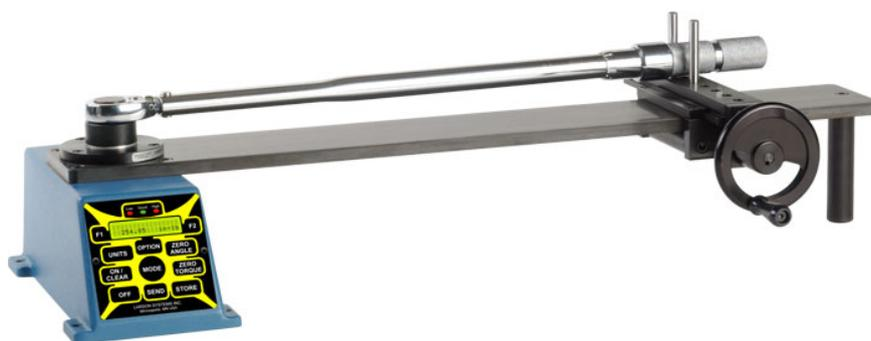
Slika 10. STWCS mjerna jedinica s priključkom za opterećivanje [6]
