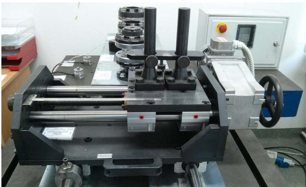
**Slika 11. Mehanizam za opterećivanje uređaja**
