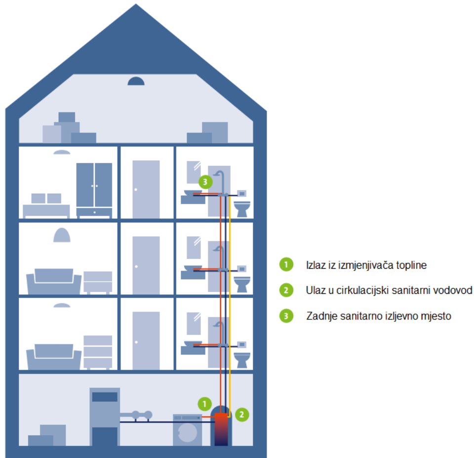
Slika 7. Pozicije za uzimanje uzoraka potrošne tople vode [12]
