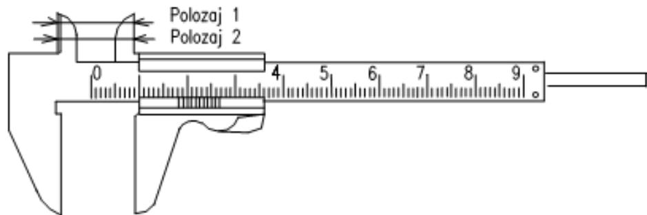
**Slika 22.** Mjerenje neparalelnosti površina za unutarnja mjerjenja [10]
