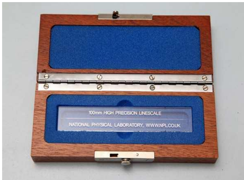
Slika 11. Precizna staklena mjerna skala NPL, SM/RET 228-513 [15]
