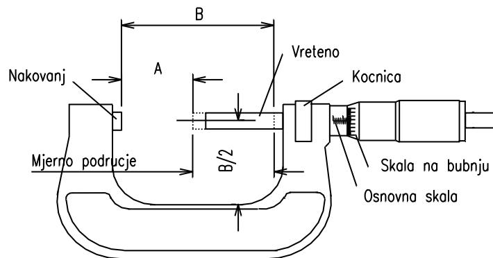
**Slika 32.** Sastavni dijelovi mikrometra za vanjska mjerena [11]
