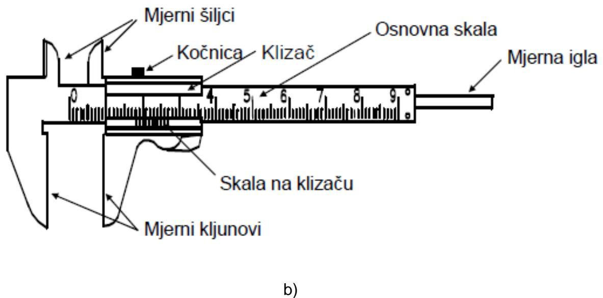
**Slika 18.** Sastavni dijelovi pomičnog mjerila [10]
