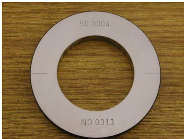
Slika 10. Etalonski mjerni prsten Joint [15]
