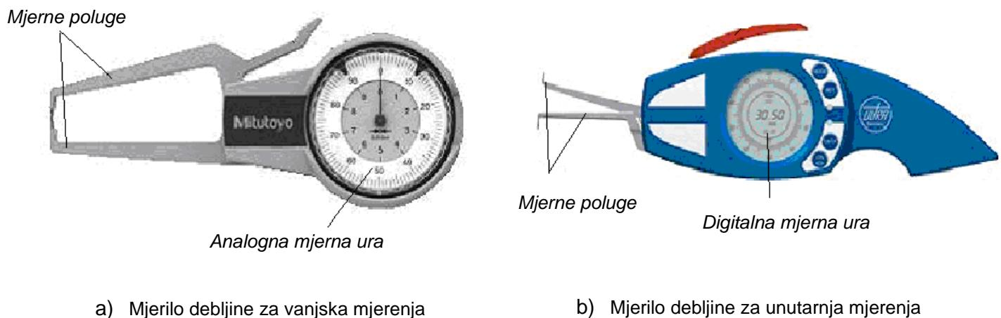
**Slika 52.** Sastavni dijelovi mjerila deblijine s mjernom urom [9]
