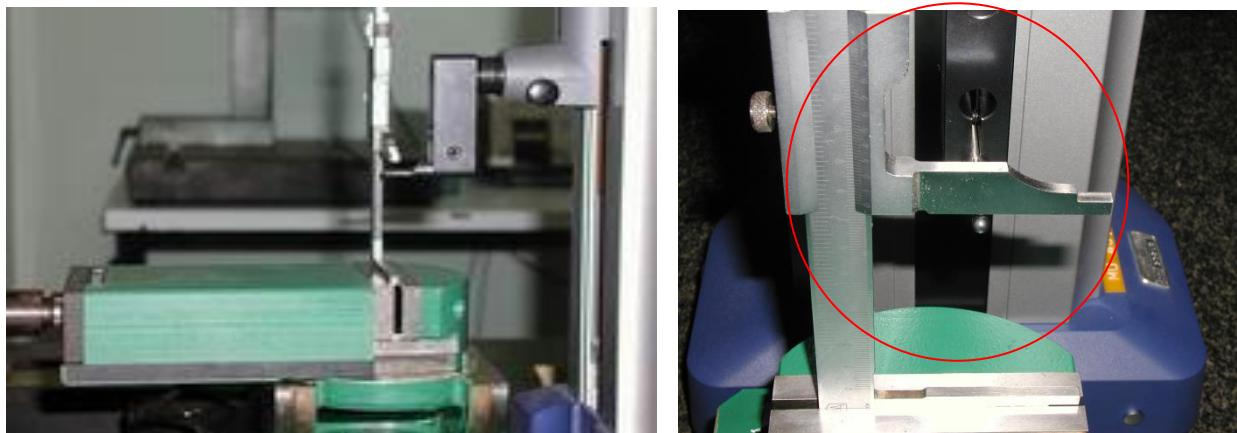
Mjerenje izvršiti na dva mesta uzduž mjernih površina, a neparalelnost izraziti kao razliku dobivenih rezultata mjerena.
