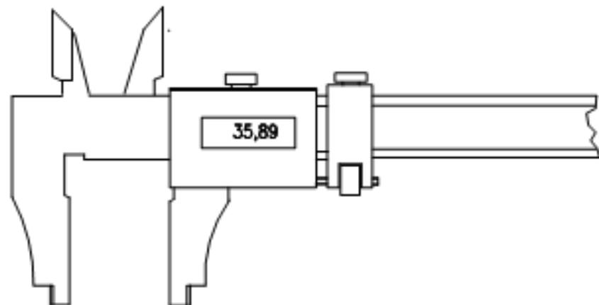
**Slika 16.** Pomično mjerilo tipa D prema DIN 862 [10]
