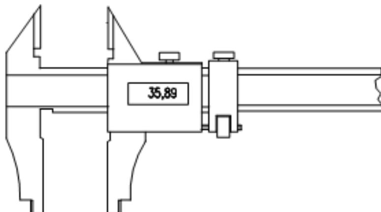
Slika 15. Pomično mjerilo tipa B prema DIN 862 [10]
