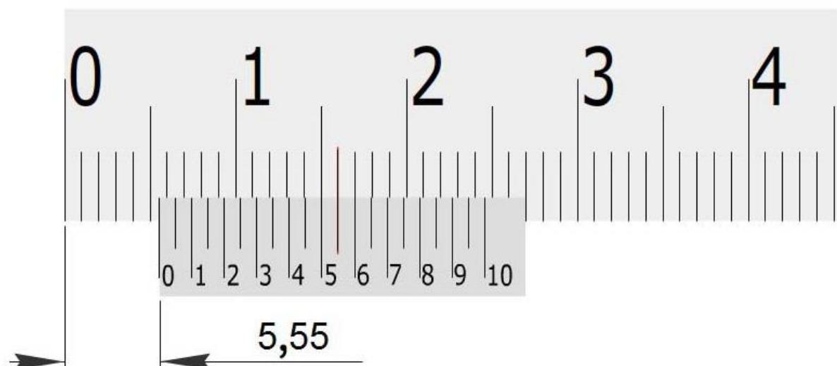
**Slika 20.** Prikaz očitanja na klasičnom pomičnom mjerilu rezolucije 0,05 mm [14]
