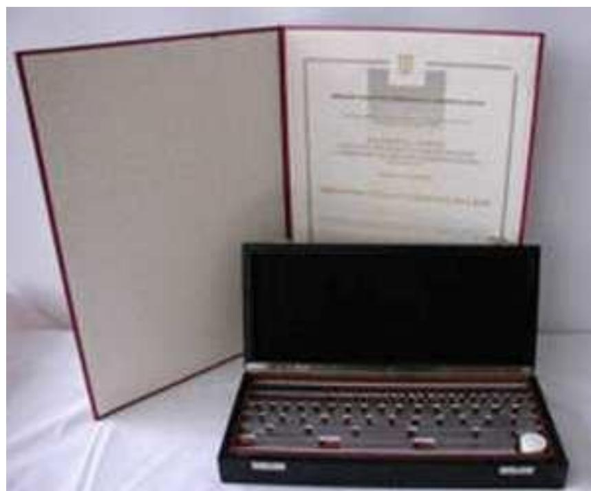
**Slika 9.** Planparalelne granične mjerke [15]
