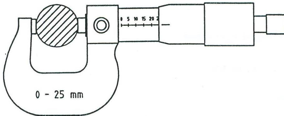
**Slika 56.** Mjerenje vanjskog promjera vratila ( $\varnothing 25\text{ mm}$ ) [13]
