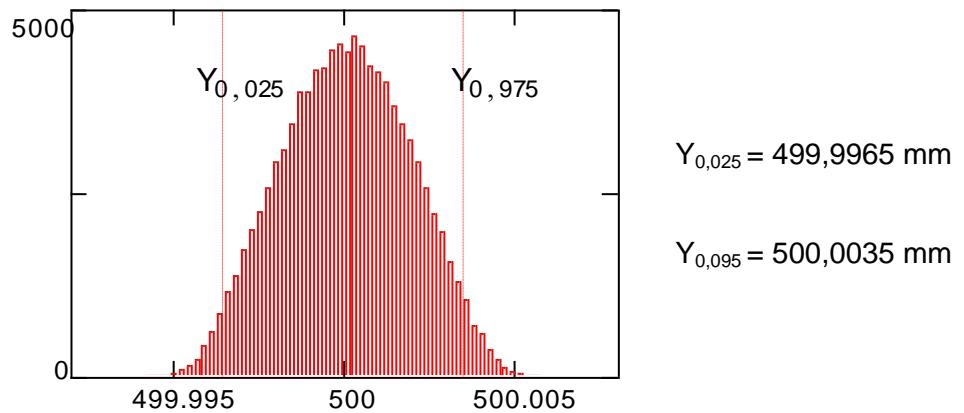
**Slika 39.** Funkcija gustoće vjerojatnosti  $g(L_x)$  mikrometra za vanjska mjerjenja mjernog područja do 500 mm i rezolucije 0,001 mm [11]
