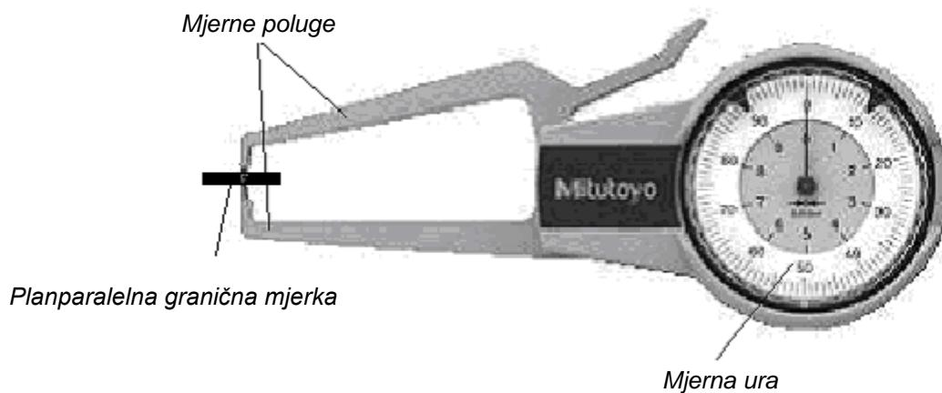
**Slika 53.** Utvrđivanje mjerne pogreške mjerila debljine za vanjska mjerjenja [9]
