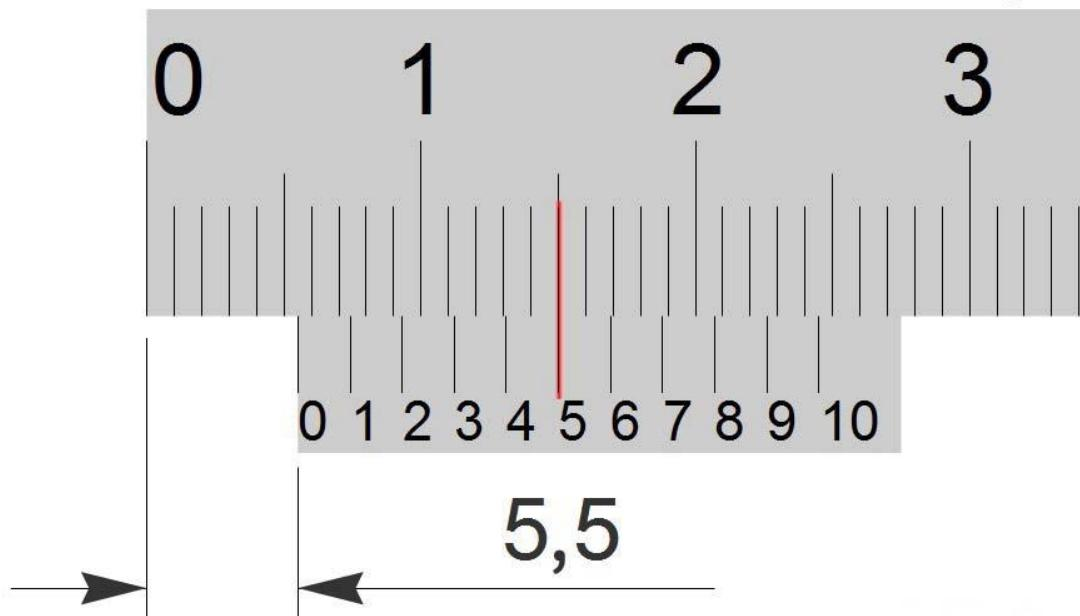
**Slika 19.** Prikaz očitanja na klasičnom pomičnom mjerilu rezolucije 0,1 mm [14]
