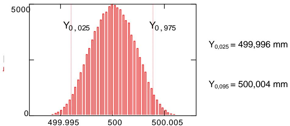
**Slika 38.** Funkcija gustoće vjerojatnosti  $g(L_x)$  mikrometra za vanjska mjerjenja mjernog područja 500 mm i rezolucije 0,01 mm [11]
