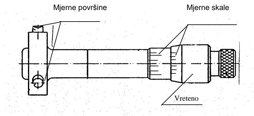
**Slika 41.** Sastavni dijelovi trokrakog mikrometra [12]
