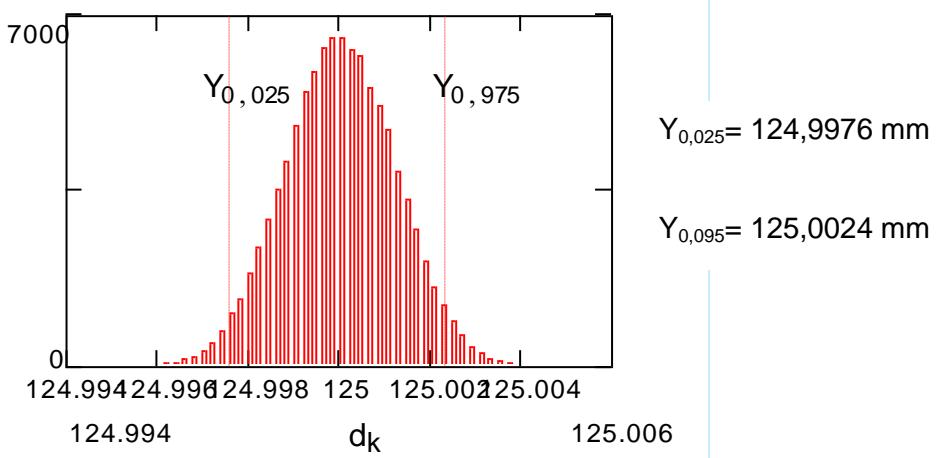
**Slika 43.** Funkcija gustoće vjerojatnosti  $g(d_x)$  za mikrometar rezolucije 0,01 mm i mjernog područja 125 mm [12]
