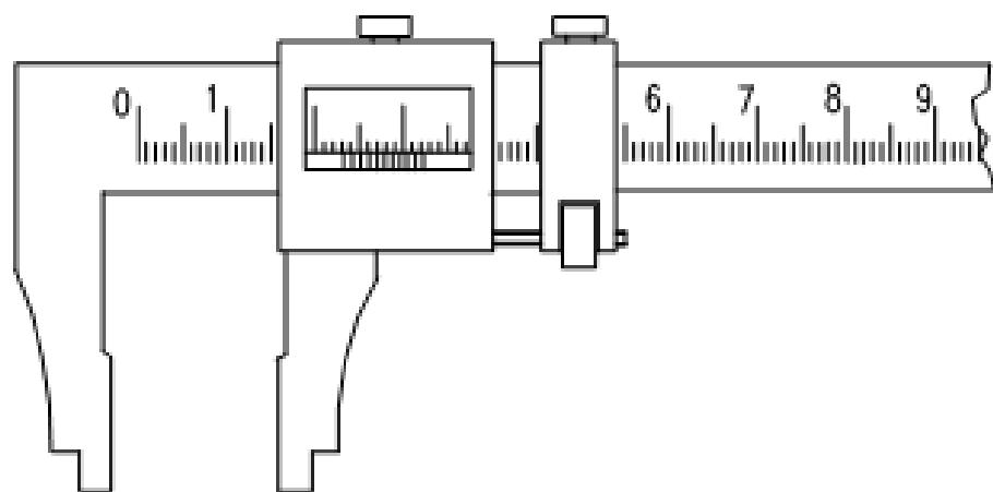
**Slika 17.** Pomično mjerilo tipa E prema DIN 862 [10]
