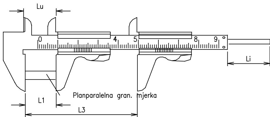
**Slika 24.** Utvrđivanje pogreške mjerena [10]
