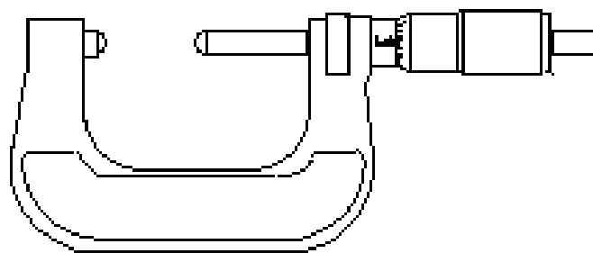
**Slika 28.** Mikrometar za vanjska mjerena s kuglastim mjernim površinama [11]
