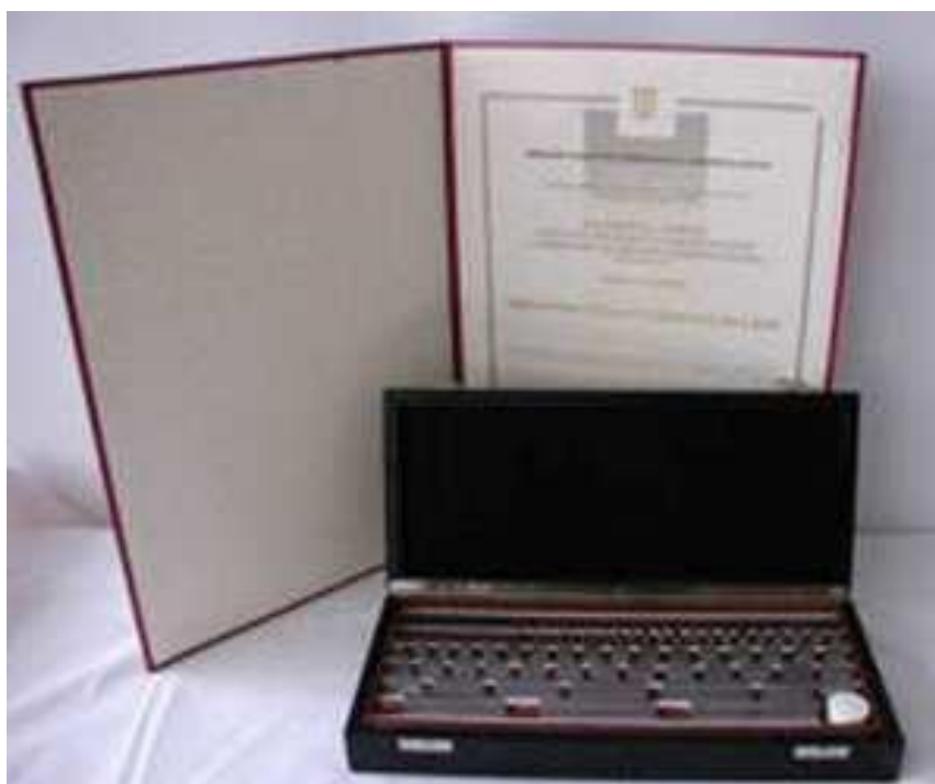
Slika 9. Planparalelne granične mjerke [15]
