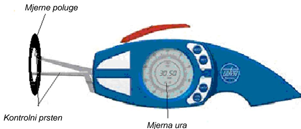
**Slika 54.** Sastavni dijelovi mjerila debljine s mjernom urom [9]
