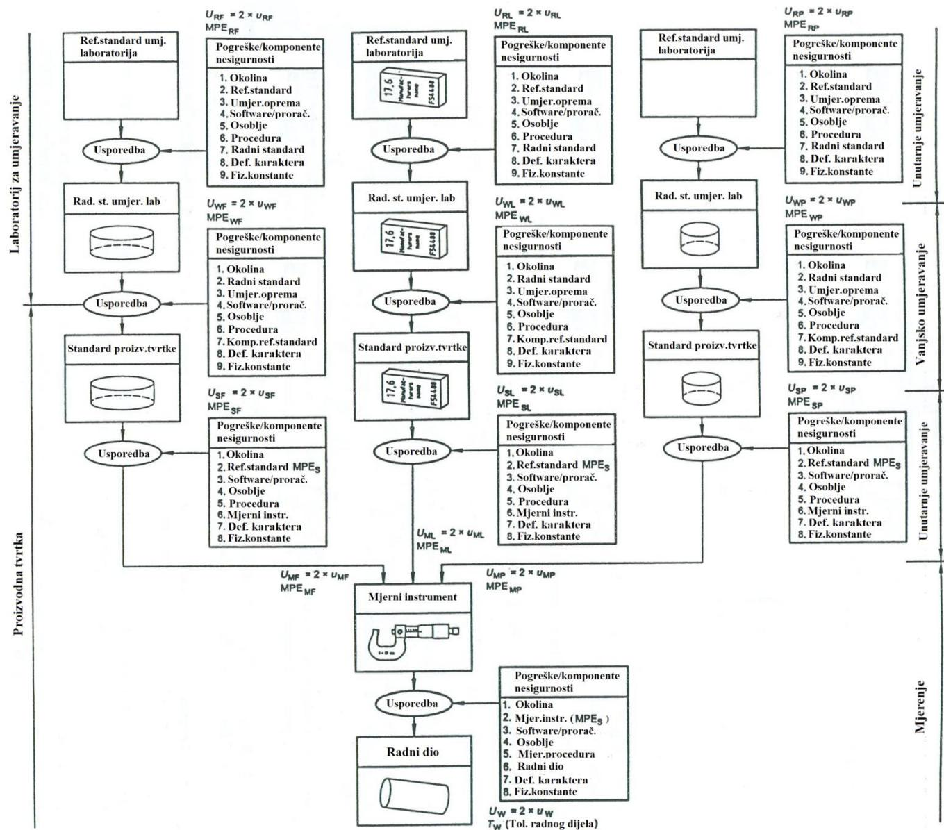
**Slika 55.** Hjерархија умјеравања за мјеренја промјера и умјеравање микрометра за ванjsка мјеренја [13]
