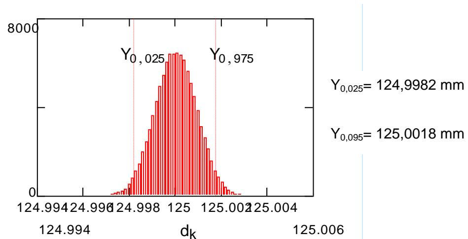
**Slika 42.** Funkcija gustoće vjerojatnosti  $g(d_x)$  za mikrometar rezolucije 0,001 mm i mjernog područja 125 mm [12]
