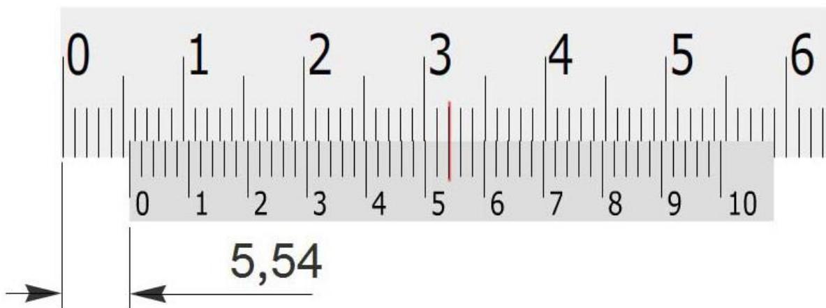
**Slika 21.** Prikaz očitanja na klasičnom pomičnom mjerilu rezolucije 0,02 mm [14]
