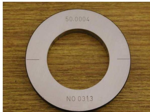
**Slika 10.** Etalonski mjerni prsten Joint [15]
