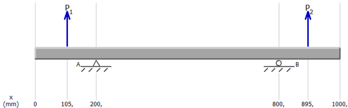
Slika 32. Opterećenje gornjeg vratila u vertikalnoj ravni
