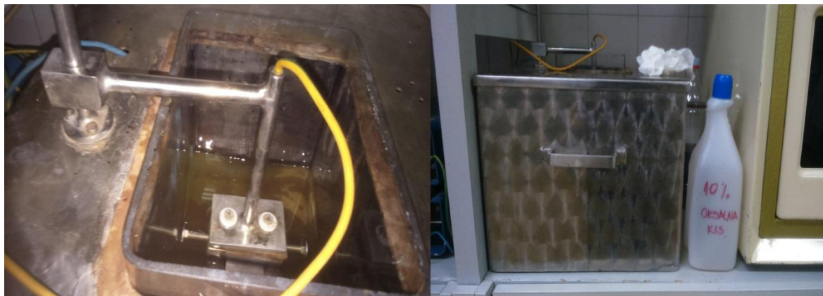
Slika 29: Elektrolitičko nagrizanje u 10% oksalnoj otopini
