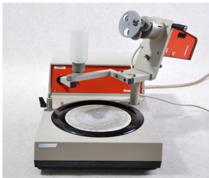
Slika 27: Uređaj za brušenje i poliranje (Struers DAP-V)
