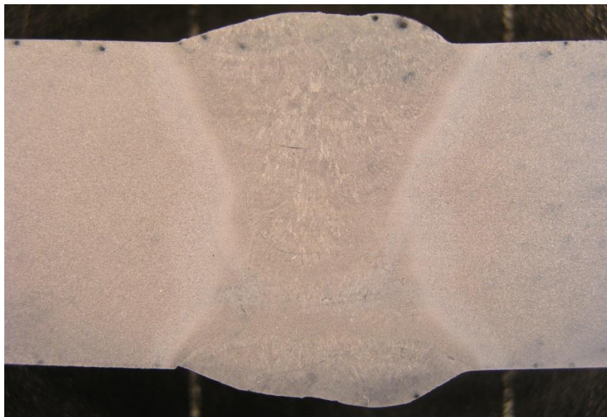
Slika 41: Makro nagriženi uzorak zavarenog spoja (2)
