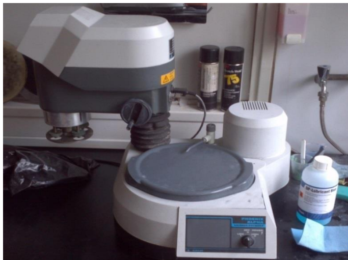
Slika 26: Uređaj za brušenje Buehler: Phoenix Alpha
