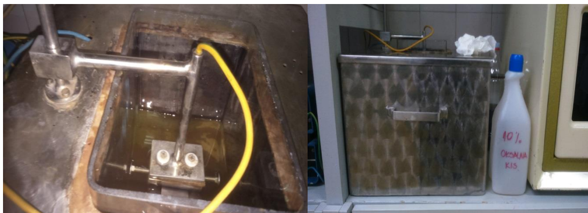
Slika 29: Elektrolitičko nagrizanje u 10% oksalnoj otopini
