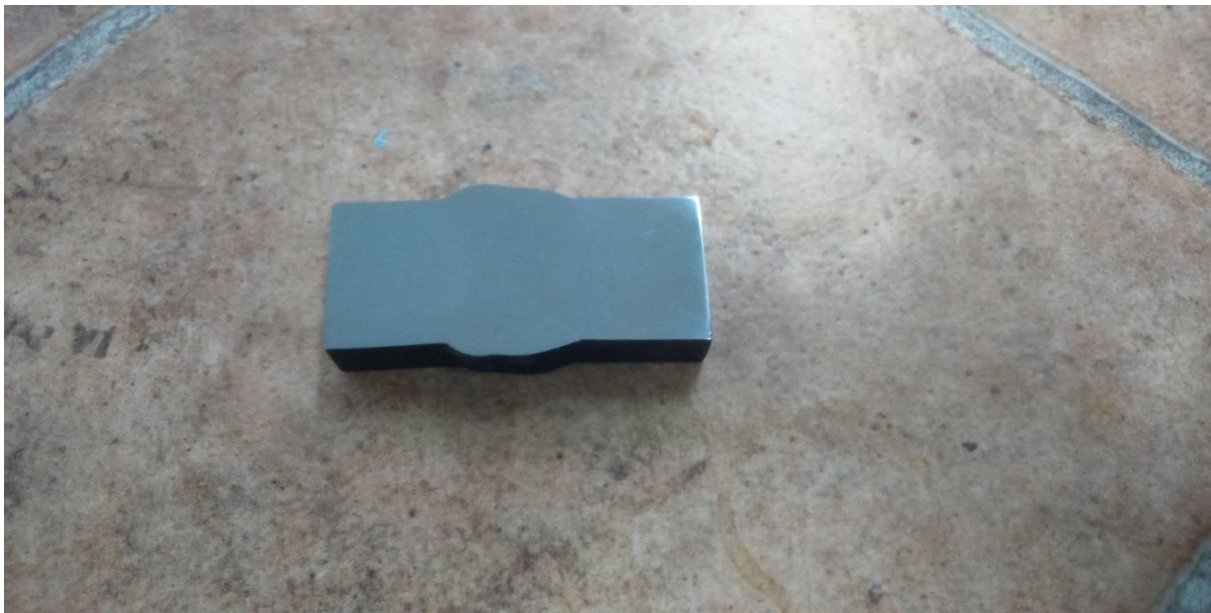
Slika 25: Ispitni uzorak čelika X3CrNiMo 13-4
