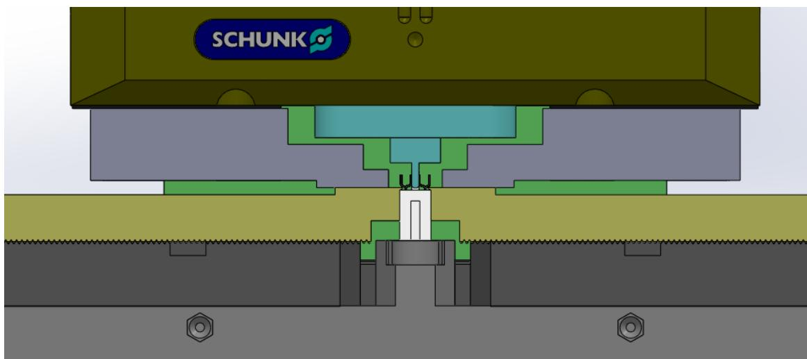
Slika 44. Priključak PCI s iglicama prije odvajanja
