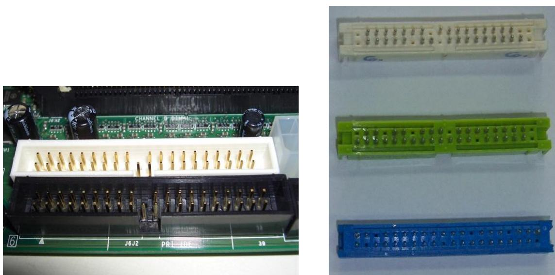
Slika 7. IDE priključak spojen na matičnu ploču i nakon odvajanja s matične
