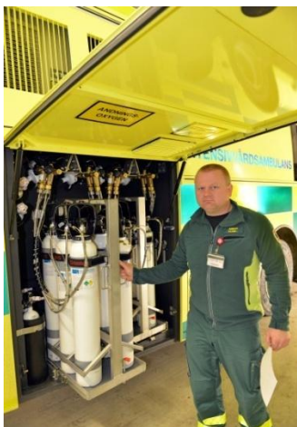
Slika 2.9. Odjeljak sa spremnicima kisika
