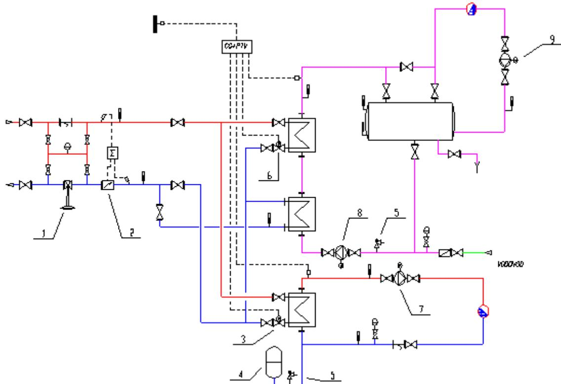
*Slika 4.3. Načelna shema vrelovodne indirektne toplinske stanice za centralno grijanje i pripremu PTV; 1. Regulator diferencijalnog tlaka 2. Kalorimetar 3. EMV za regulaciju centralnog grijanja 4. Ekspanzijska posuda 5. Sigurnosni ventil 6. EMV za regulaciju PTV 7. Crpka za grijanje 8. Crpka za cirkulaciju PTV 9. Crpka za recirkulaciju PTV[5]*
