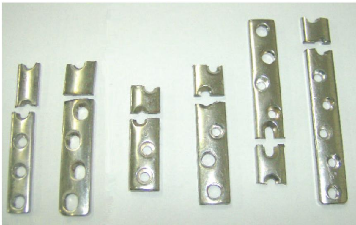
Slika 6.4. Puknute osteosintetske pločice od AISI 316L nehrđajućeg čelika [18]
