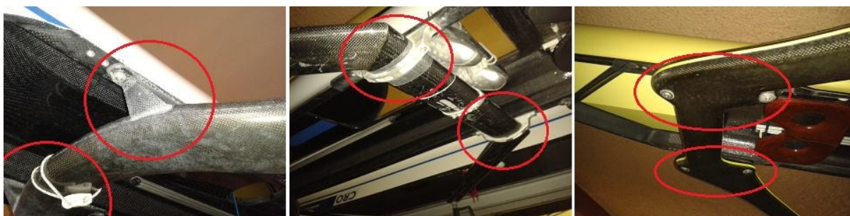
Slika 16. Mjesta spajanja ugljičnih krila i trupa: nosači od ugljičnih vlakana (lijevo), aluminijski nosači (sredina), direktan spoj izbočnika i trupa čamca (desno)
