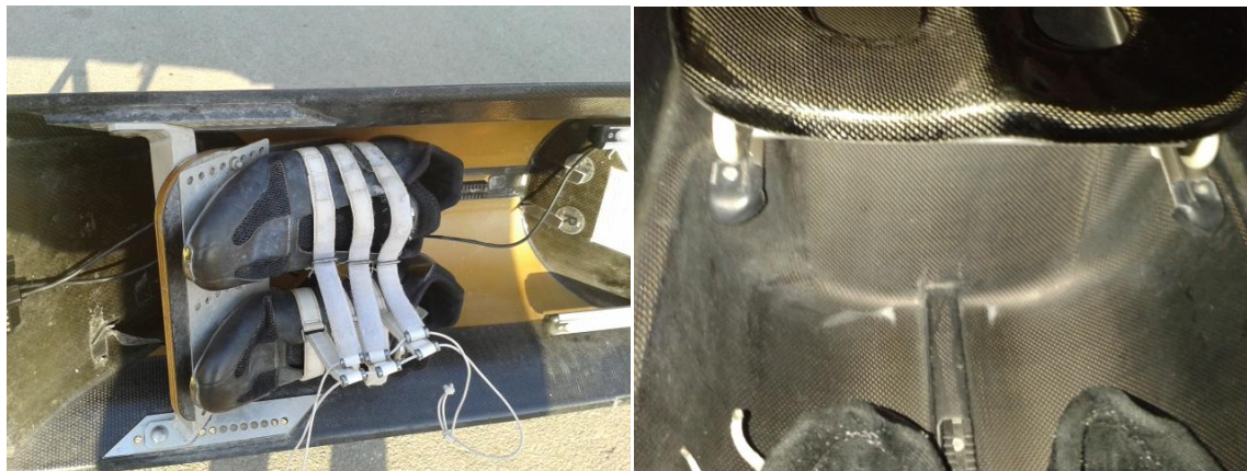
Slika 8. Unutrašnjost čamca s aramidnom osnovom (lijevo) i s ugljičnom osnovom (desno)
