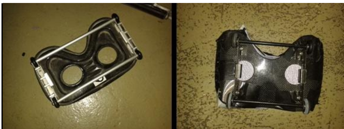
Slika 20. Pomično sjedalo od ugljičnih vlakana luskaste građe (lijevo) i drveno pomično sjedalo prevučeno ugljičnim vlaknima (desno)
