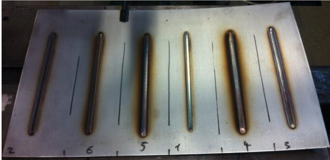
Slika 38. Ispitna ploča s navarima
