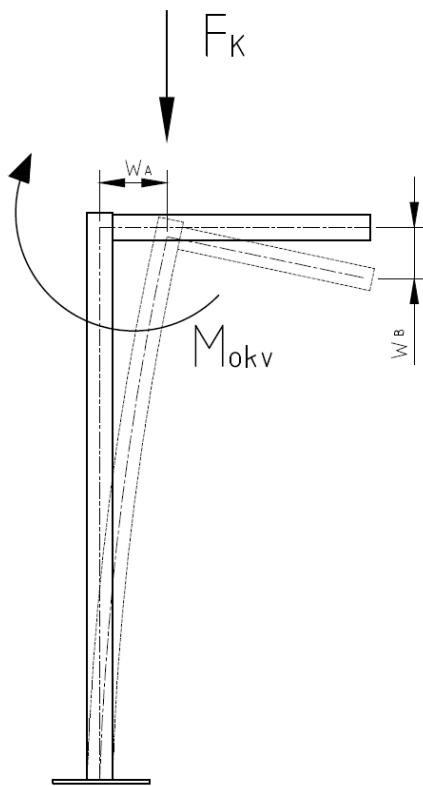
**Slika 21. Savijanje stupa**
