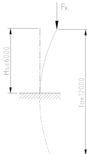
Slika 20. Izvijanje stupa
