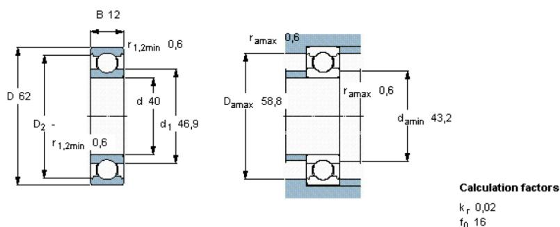
Slika 14. Jednoredni kuglični ležaj 61908
