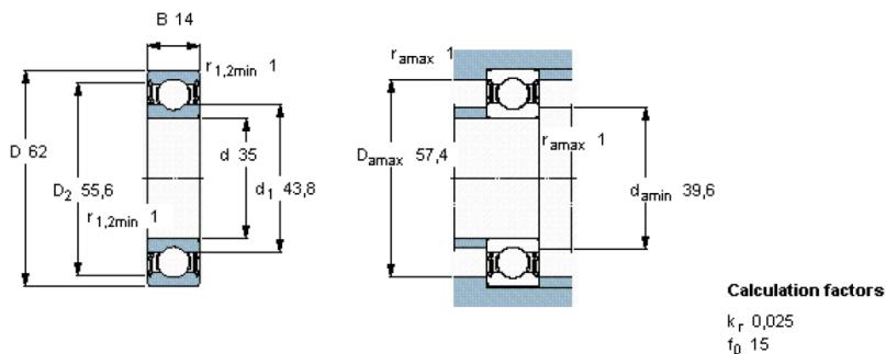
Slika 17. Jednoredni kuglični ležaj 6007-2RS1
