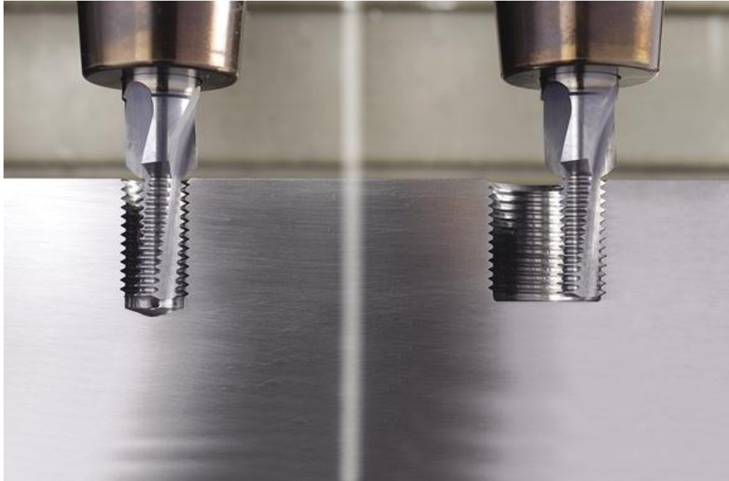
Slika 37. Glodanje različitih promjera navoja istim alatom
