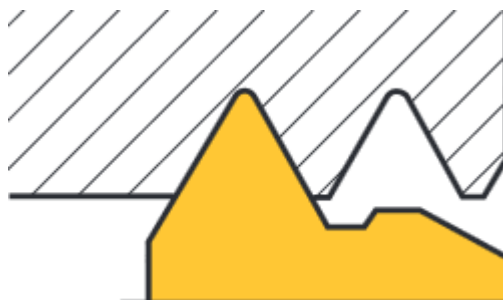
Slika 28. Rezna pločica za V - profil [12]
