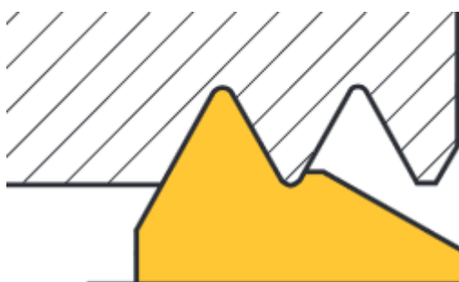
Slika 27. Rezna pločica za puni profil [12]
