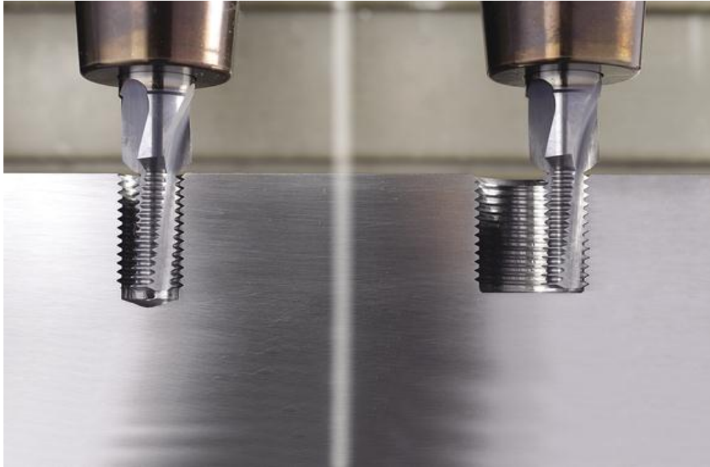
Slika 37. Glodanje različitih promjera navoja istim alatom
