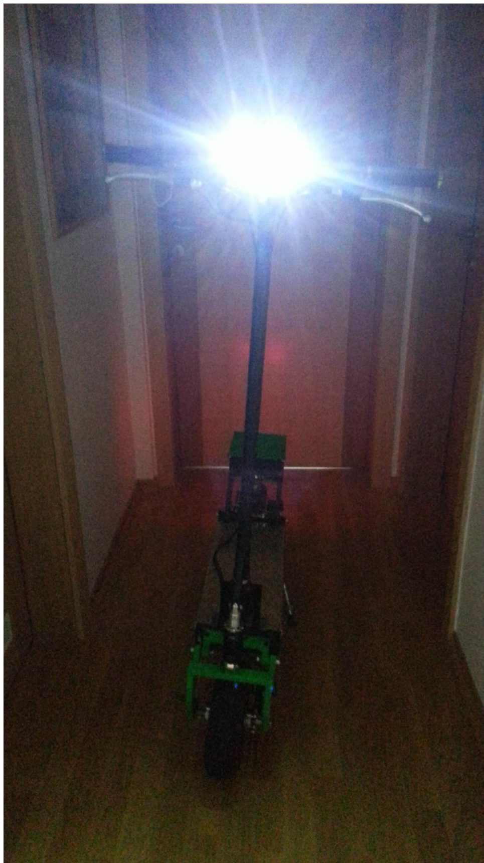
Slika 43. Prednje LED svjetlo ukupne snage 12W
