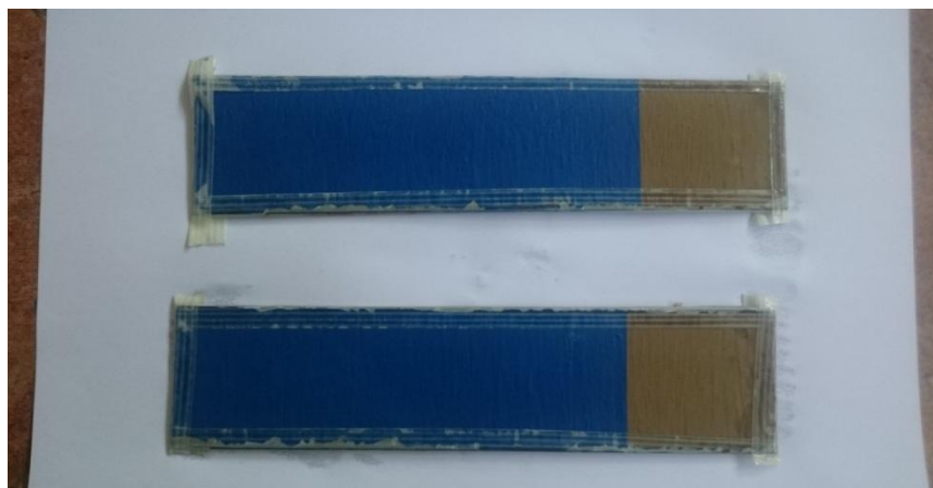
Slika 25. Ispitni uzorci nakon ispitivanja u vlažnoj komori
