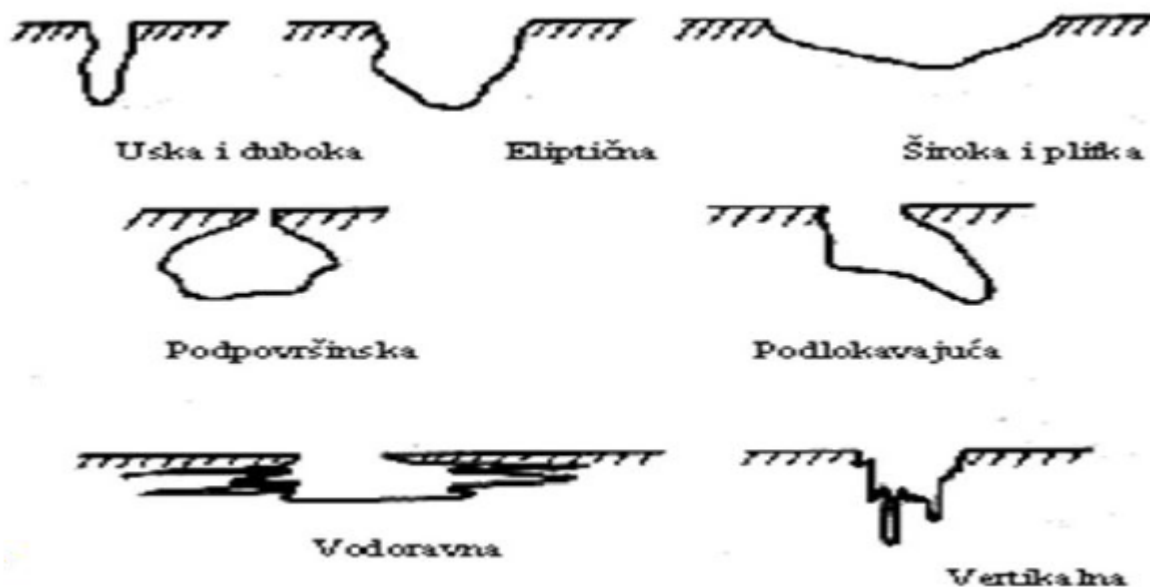
Slika 5. Tipični oblici pitova [6]
