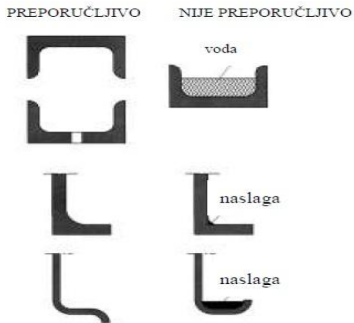
Slika 7. Sprečavanje nastanka vodenih džepova i stvaranja naslaga [1]
