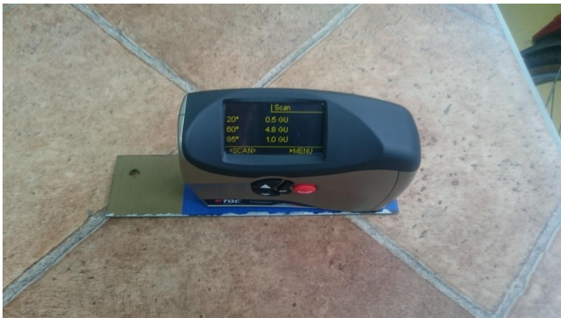
Slika 30. Uređaj za mjerenje sjaja TQC PolyGloss
