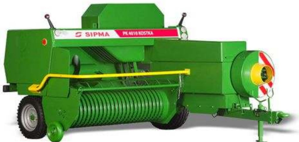
Slika 1. Visokotlačna preša za kockaste bale
