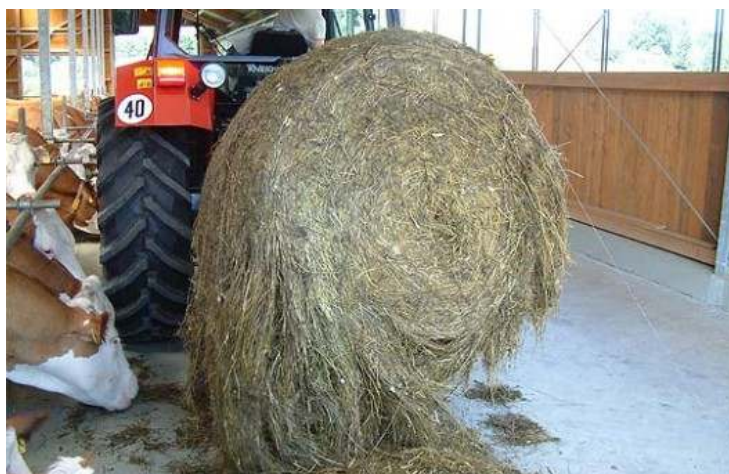
Slika 8. BZT – Odvrtač rolo bale u radu
