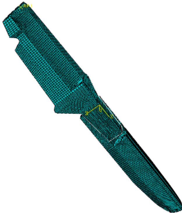
Slika 20. Model sa mrežom konačnih elemenata (42824 konačnih elemenata)
