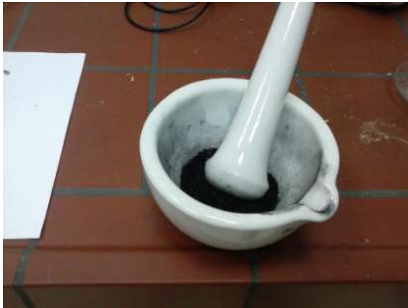
Slika 3.2. Tarionik sa usitnjenim ugljenom
