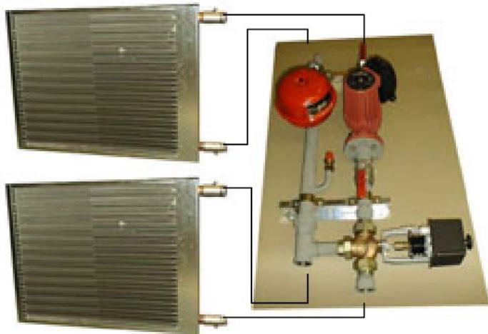
Slika 7. Kružni cirkulacijski sustav povrata topline
