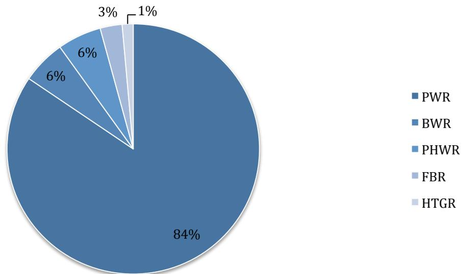
Slika 4. Vrste reaktora trenutno u izgradnji [6]
