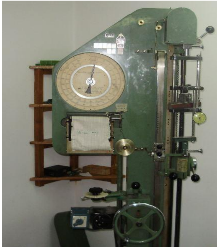
Slika 8. Ispitivanje savojne čvrstoće na univerzalnoj kidalici
