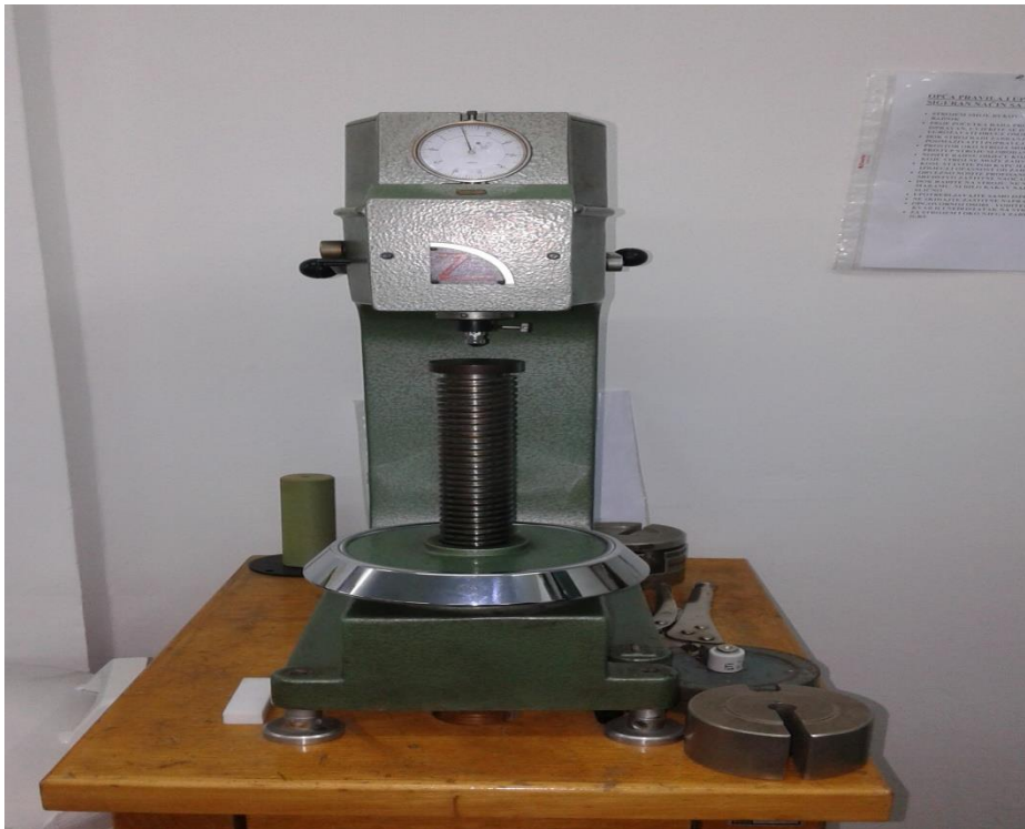
Slika 16. Ispitivanje tvrdoće na tvrdomjeru
