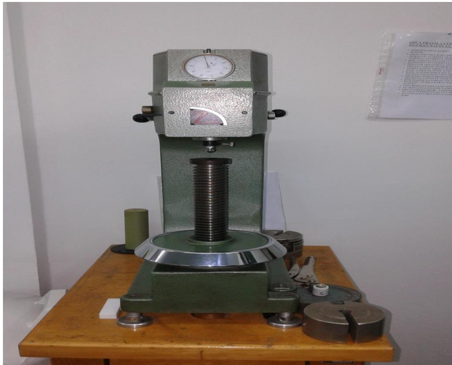
Slika 16. Ispitivanje tvrdoće na tvrdomjeru
