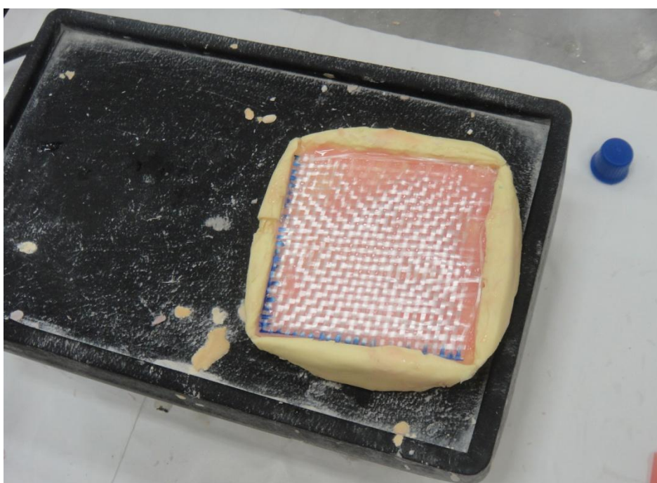
Slika 17: Stavljanje ojačanja prilikom izrade AO 2
