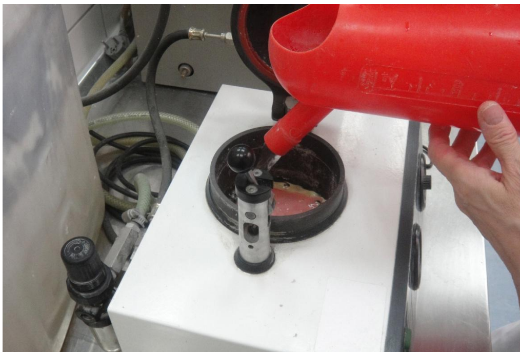
Slika 18: Ulijevanje vode u Ivomat za polimerizaciju AO_2
