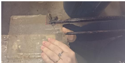
Slika 5.7. Rezanje epruveta ručnom pilom
