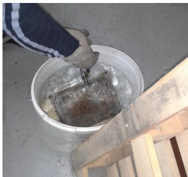
Slika 5.3. Hlađenje kalupa u vodi
