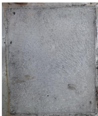
Slika 5.4. Polimerna ploča dobivena prešanjem
