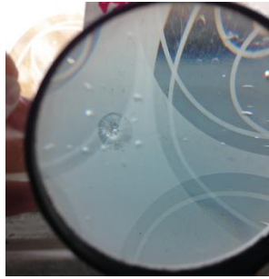
Slika 5.9. Samoobnovljeno oštećenje nakon probijanja metkom
