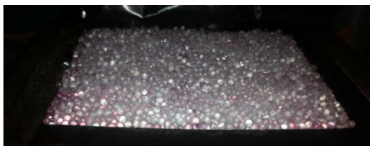
Slika 5.2. Stavljanje granulata u kalup
