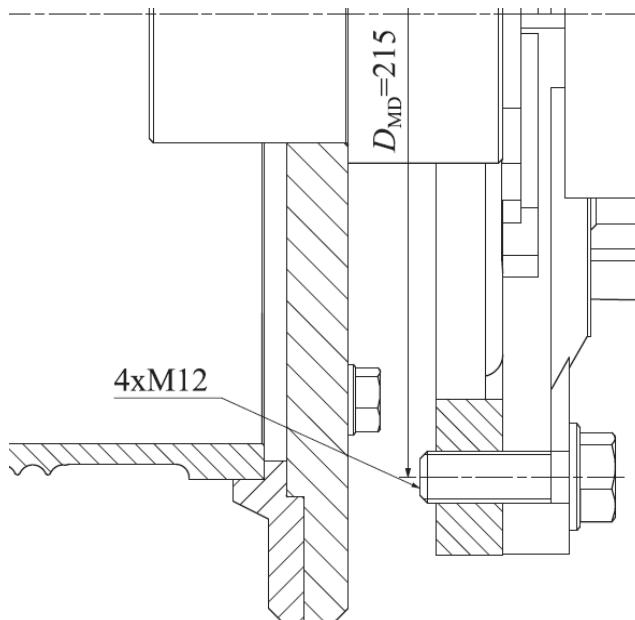
Slika 16. Prikaz spoja motora za dizanje s nosivom konstrukcijom bubenja
