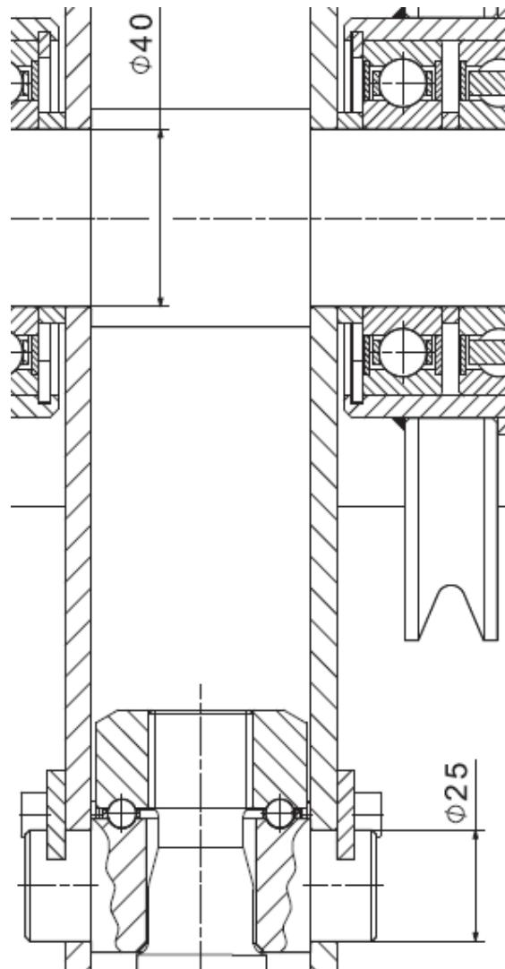
Slika 12. Prikaz dimenzija prorvta nosećih limova sklopa kuke
