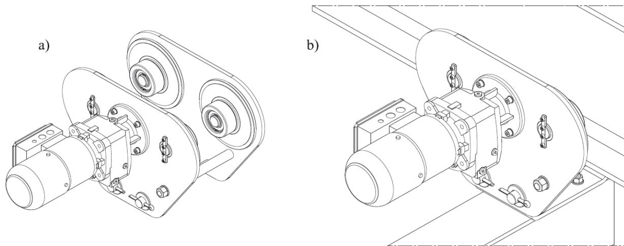
Slika 23. Izometrija mehanizma za uzdužnu vožnju, a) samostalni prizaz, b) prizak u sklopu
