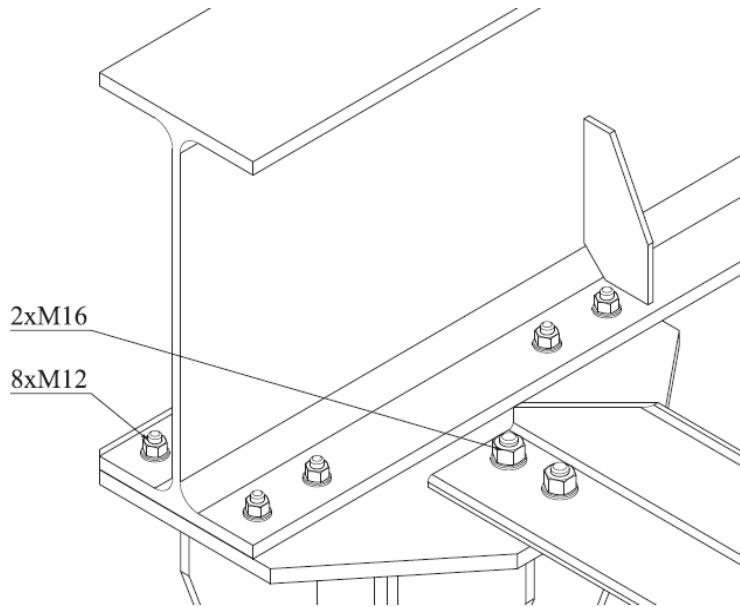
Slika 35. Primjer vijčanog spoja segmenata nosive konstrukcije
