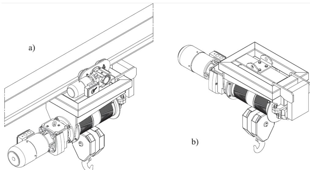
Slika 6. Izometrija mehanizma za dizanje
