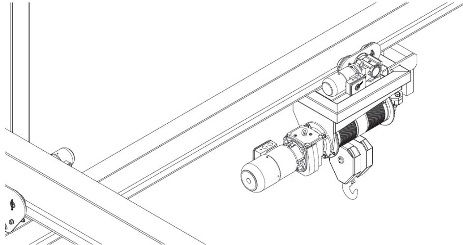
Slika 26. Prikaz najnepovoljnijeg slučaja opterećenja poprečnog nosača
