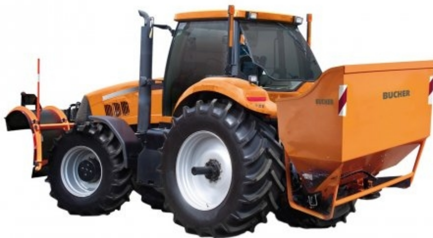
Slika 1. Traktor opremljen za zimsko održavanje cesta
