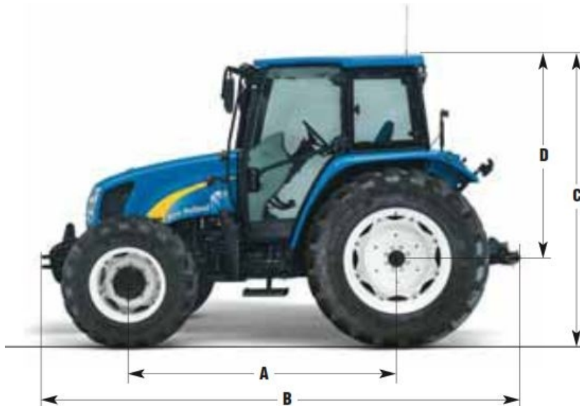
Slika 27. Gabaritne mjere traktora New Holland T5050
