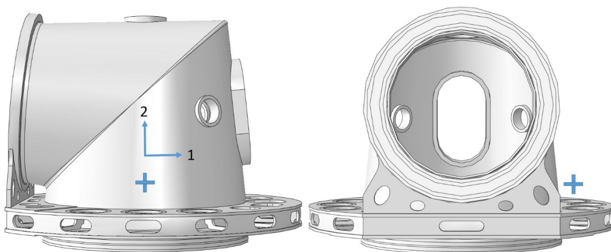
Slika 46. Prikaz glavnog nosača s označenim mjernim mjestom
