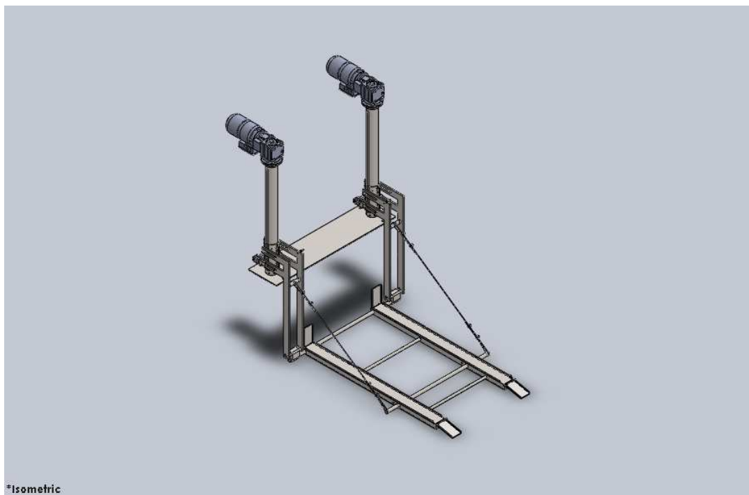
Slika 43. 3D model rampe u spušenom položaju
