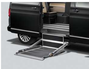
Slika 2. Bočno smještena rampa
