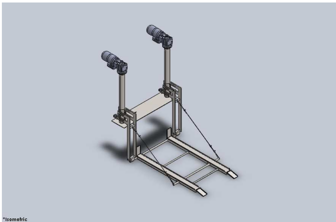
Slika 43. 3D model rampe u spušenom položaju
