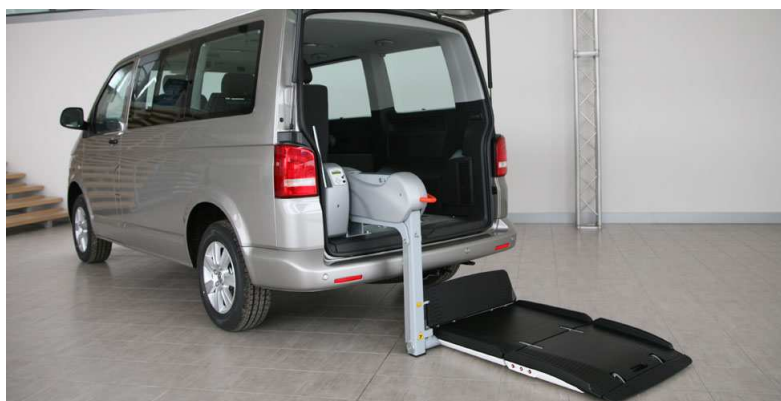
Slika 4. Vozilo s liftom smještenim u prtljažnom prostoru
