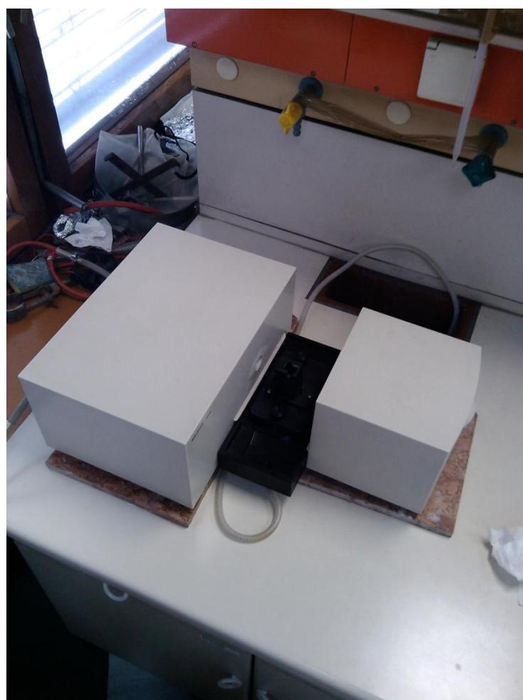
Slika 5. UV-VIS spektrofotometar (HP 8453)
