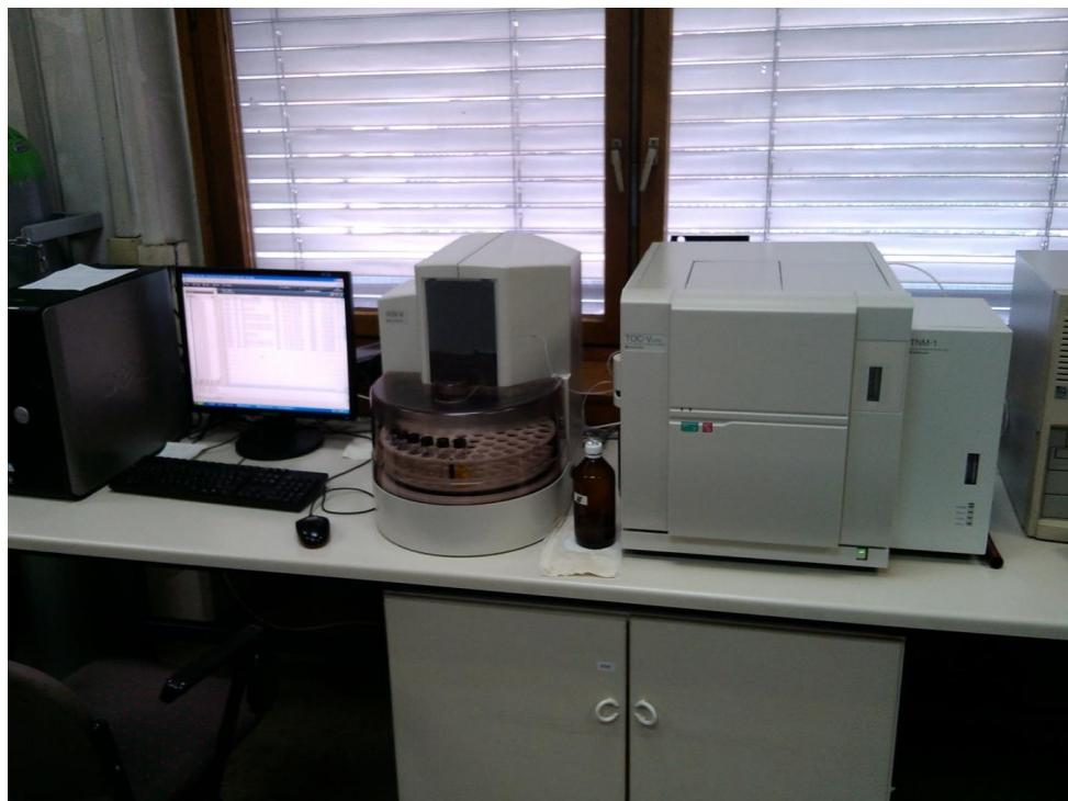
**Slika 6. Uredaj za mjerjenje ukupnog organskog ugljika – TOC analizator (Shimadzu TOC-V<sub>CPH</sub>)**
