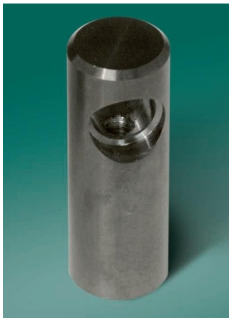
Slika 23. Prikaz DLC prevlake [12]
