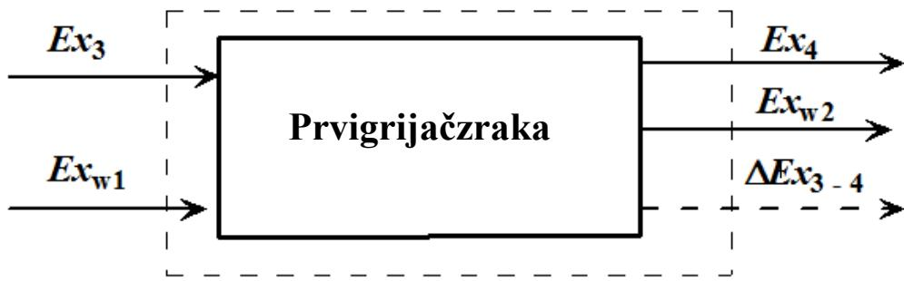
Slika 7 Shema eksergijske destrukcije unutar prvog grijajućeg zraka
