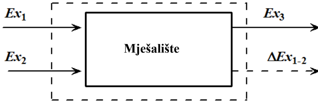
Slika 6 Shema eksergijske destrukcije u mješalištu
