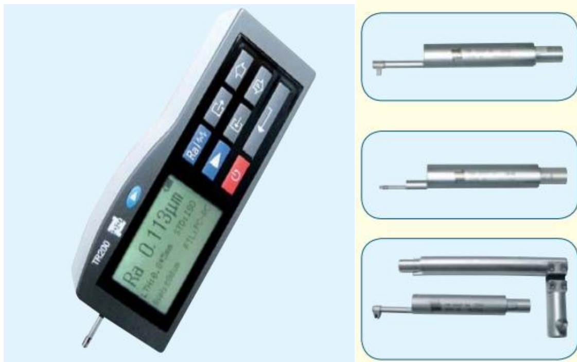
Slika17. Prijenosni uređaj i karakteristične vrste ticala
