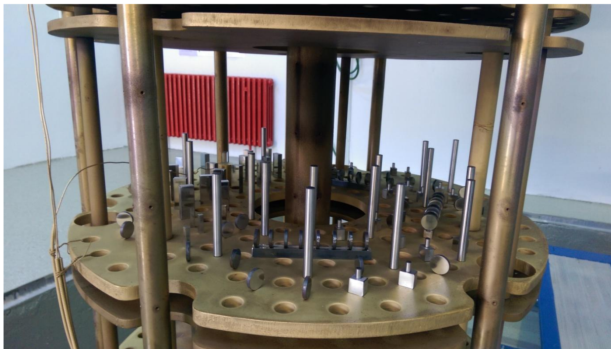
Slika 9 . Prikaz šaržirne naprave u komori PACVD-a
