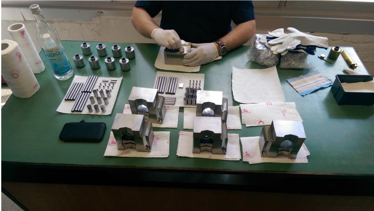
Slika 18. Završno čišćenje i odmaščivanje ispitnih uzoraka prije prevlačenja
