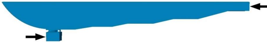
Slika 20. Mjesta uklještenja statora
