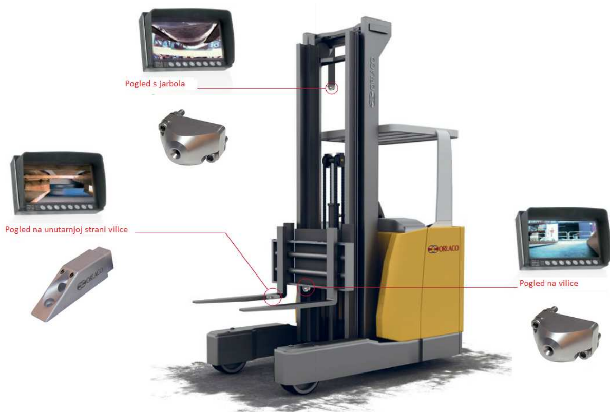
Slika 46. Mogućnosti i varijante montaže kamere [48]
