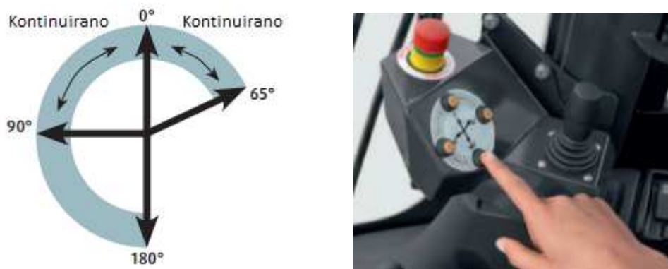
Slika 35. Kutevi zakretanja i način upravljanja [39]
