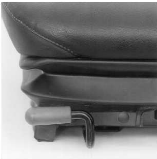
Primjer preferiranog načina za podešavanje naprijed-nazad pozicije sjedala
