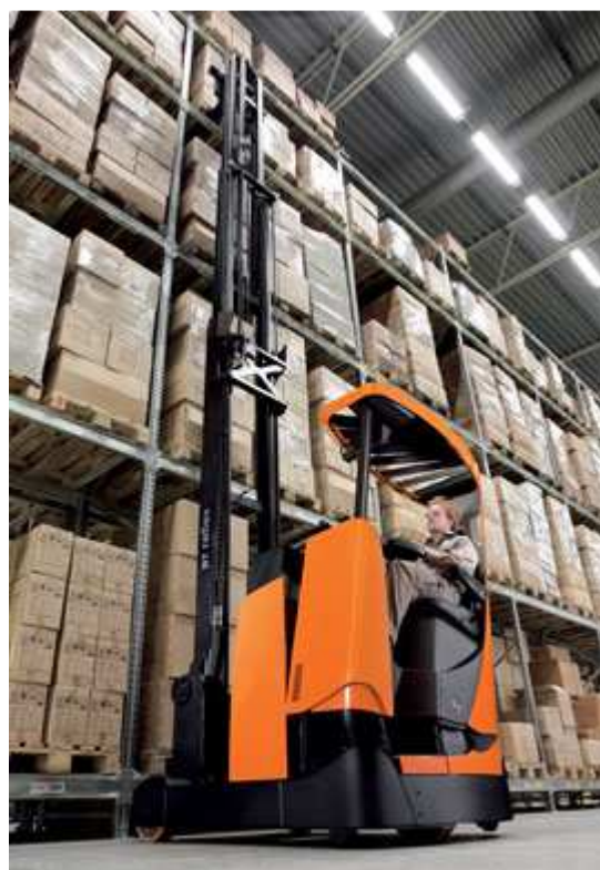
Slika 39. Toyota BT Reflex visokoregalni viličar
