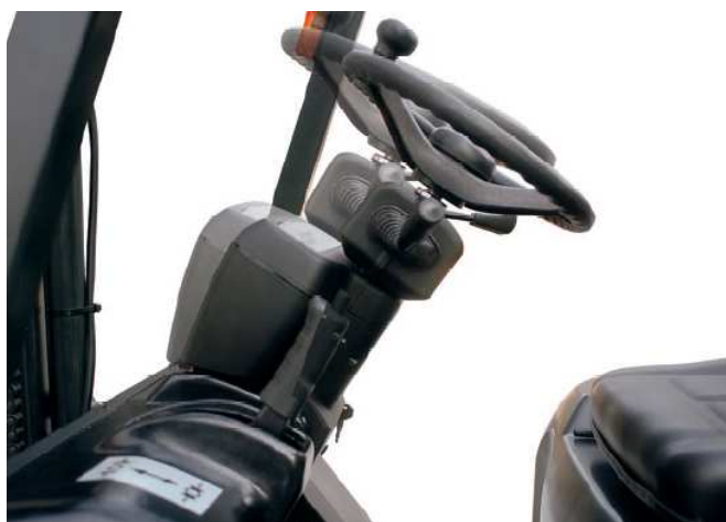
Slika 28. Podešavanje volana naprijed-nazad [61]
