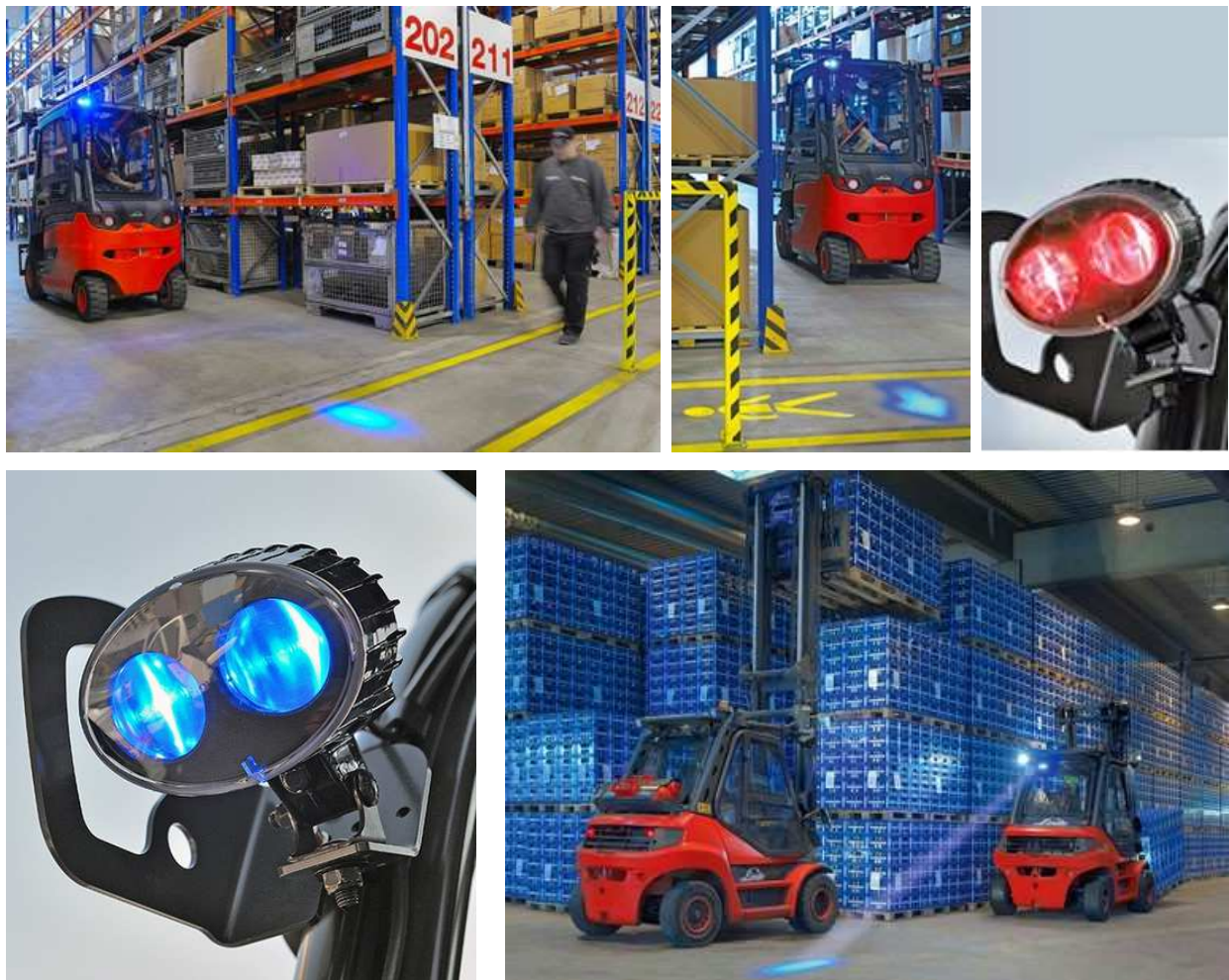
Slika 40. Linde "BlueSpot" sustav upozorenja
