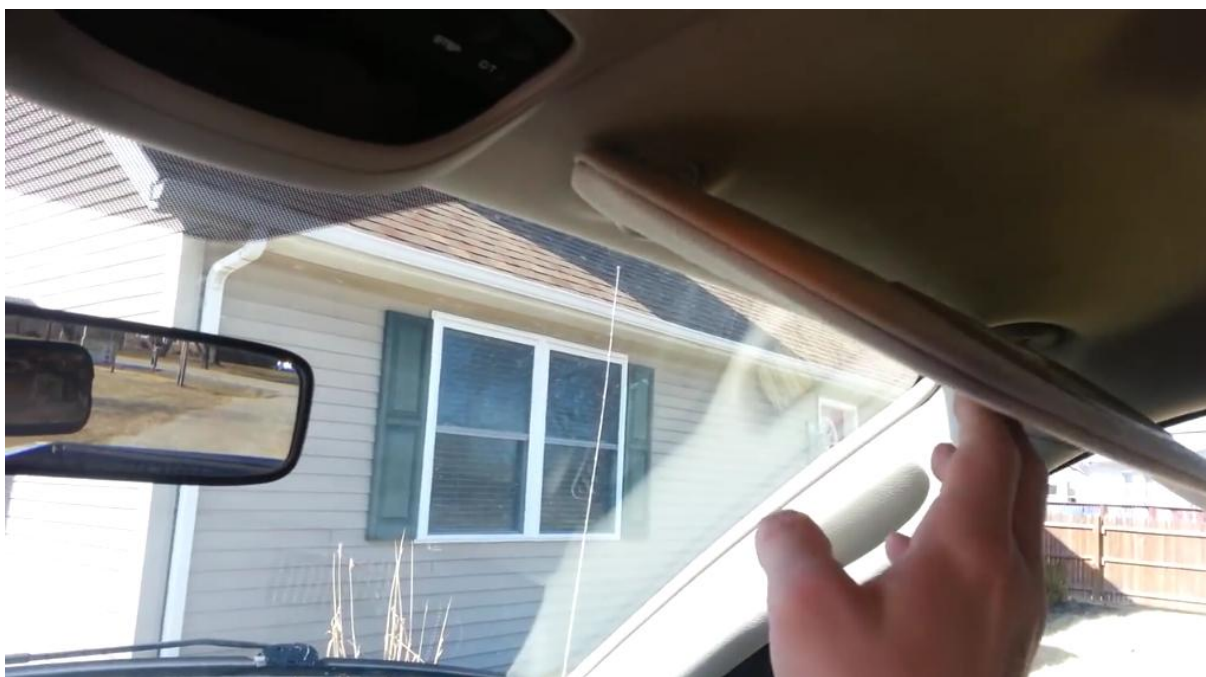
Slika 6. Istrošeno / labavo sjenilo
