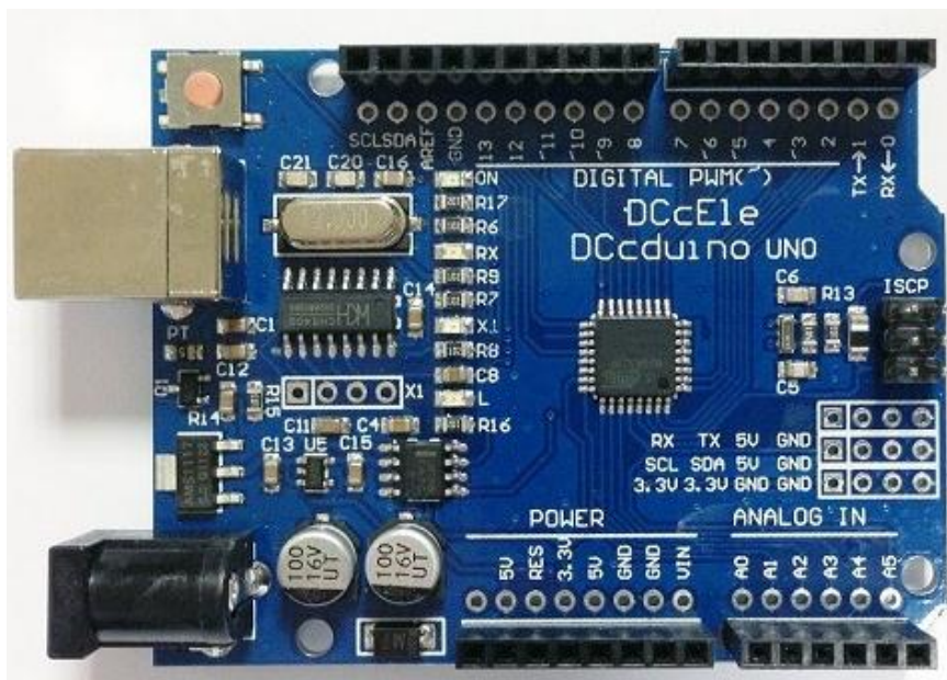
Slika 21. Mikrokontroler - DCcduino uno
