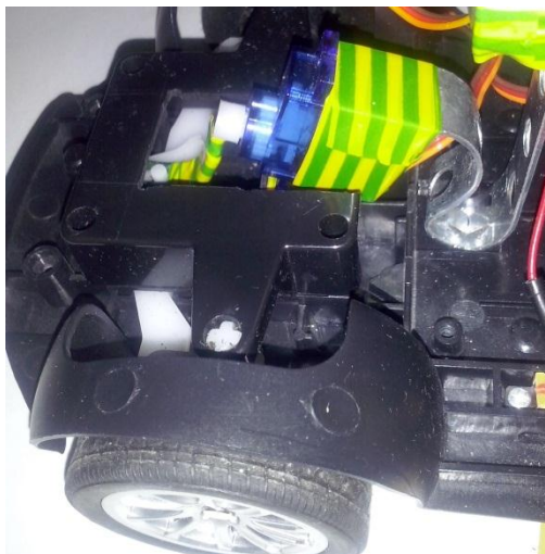
Slika 14. Sustav skretanja sa servo motorom
