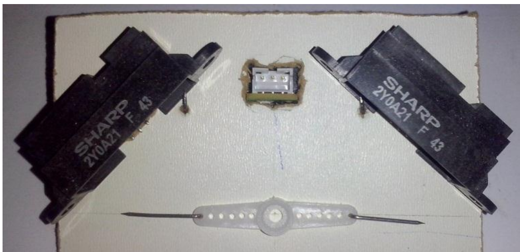
Slika 17. Tlocrt rotacijskog daljinomjera
