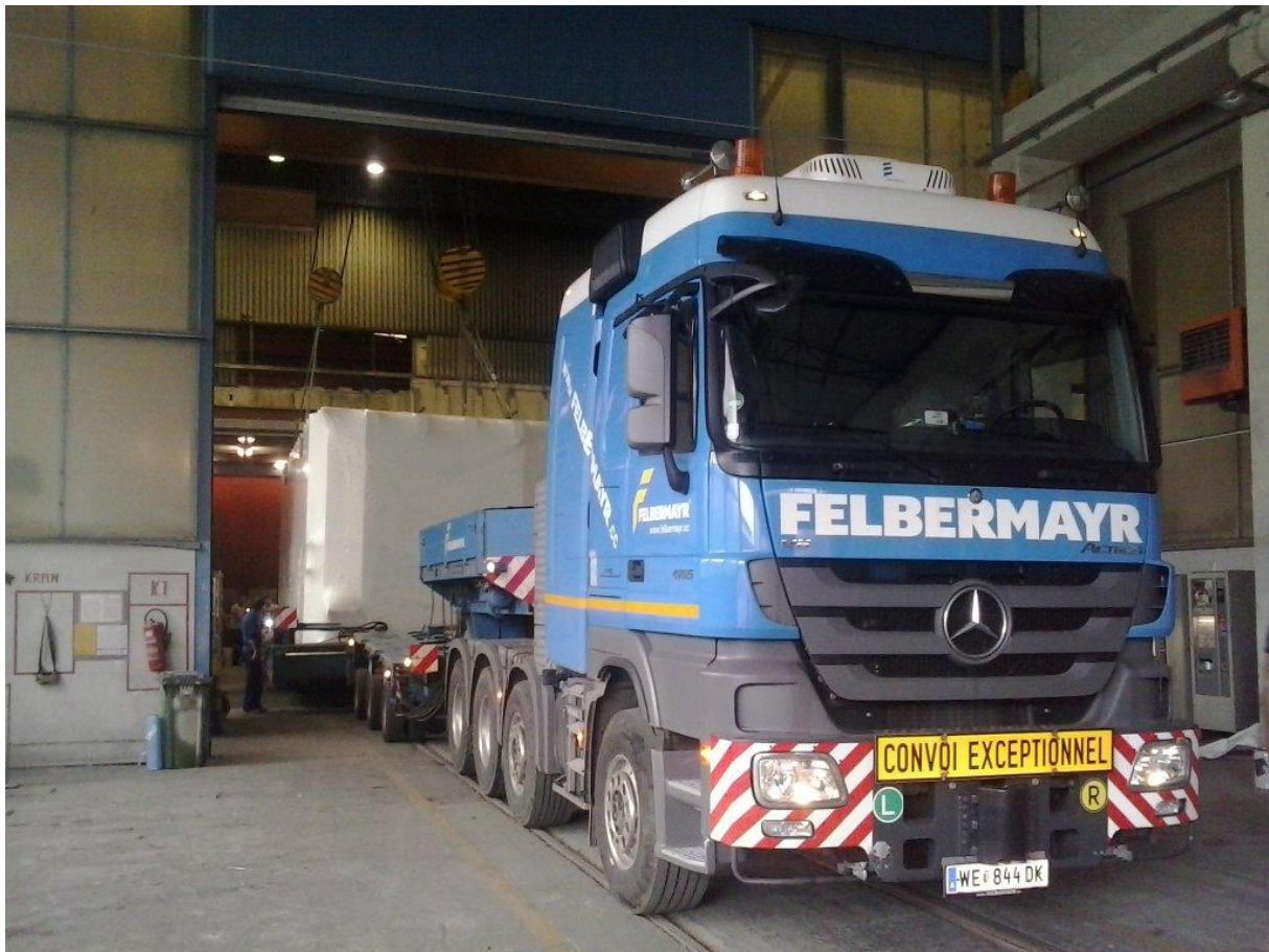
Slika 34. Utovar kotla na transportno vozilo
