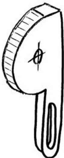
Slika 26. Poluga sa segmentoma zupčanika
