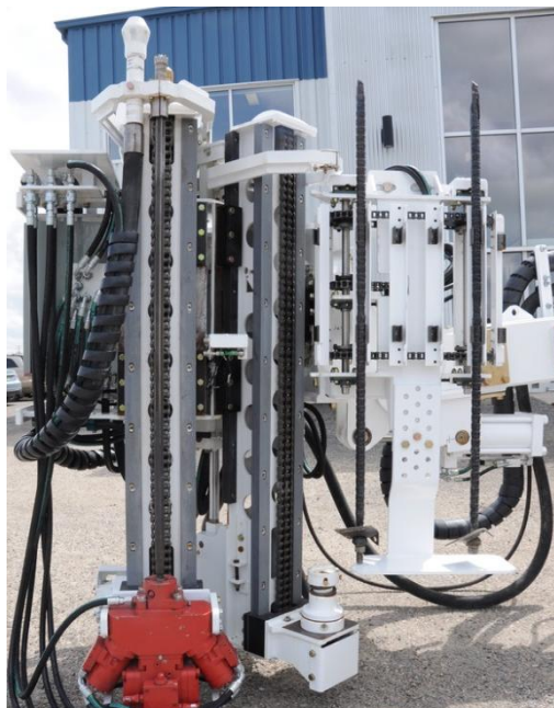
Slika 14. Prikaz sustava za dobavu sidra
