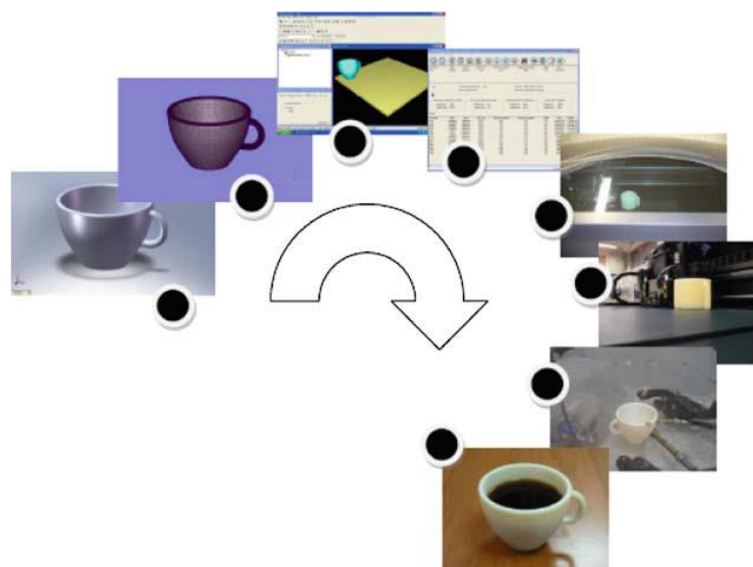
Slika 2.1. Postupak izrade dijela aditivnom tehnologijom [2]
