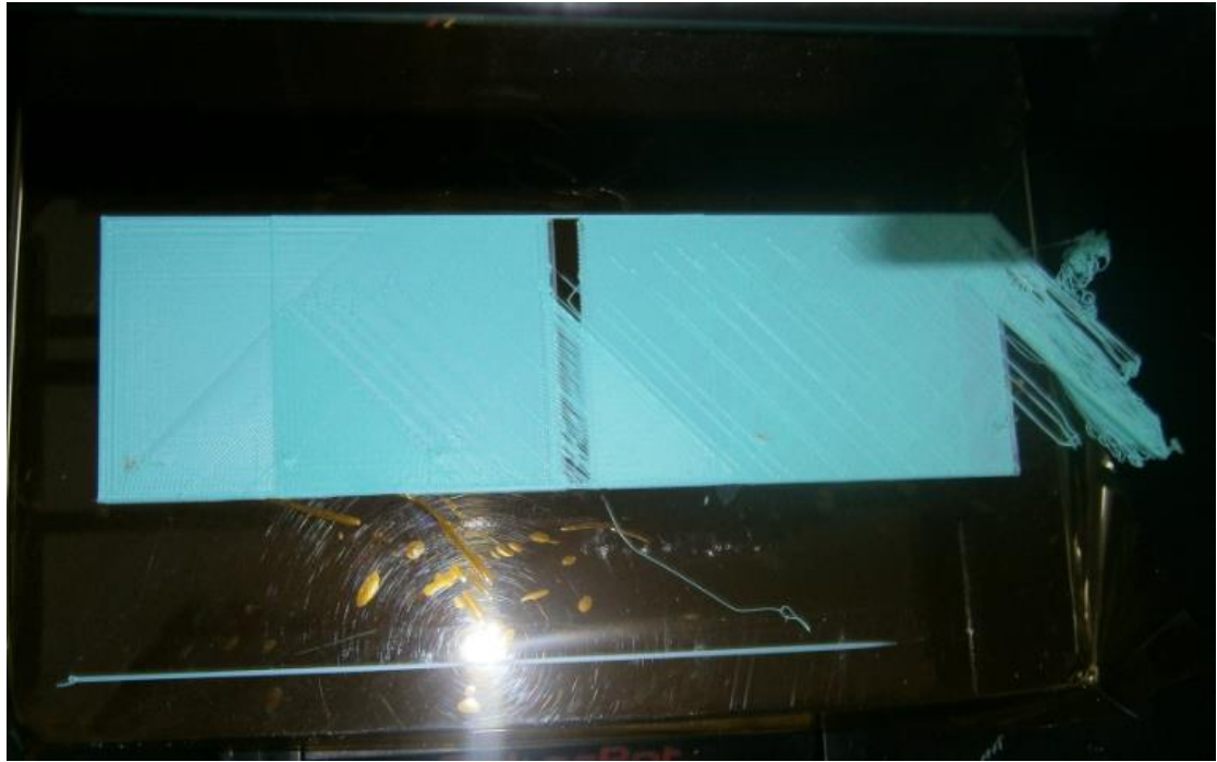
Slika 7.13 Razvlačenje niti materijala na desnom modelu
