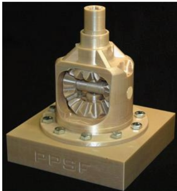
Slika 6.2 PPSF kućište zupčanika [1]
